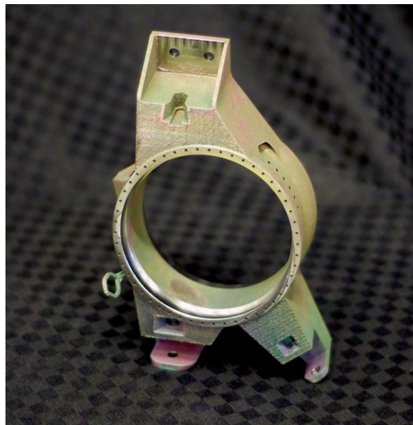
Sele 4-7 Ti64 Laserpaagutatud käänmik Revolve NTNU [11]
