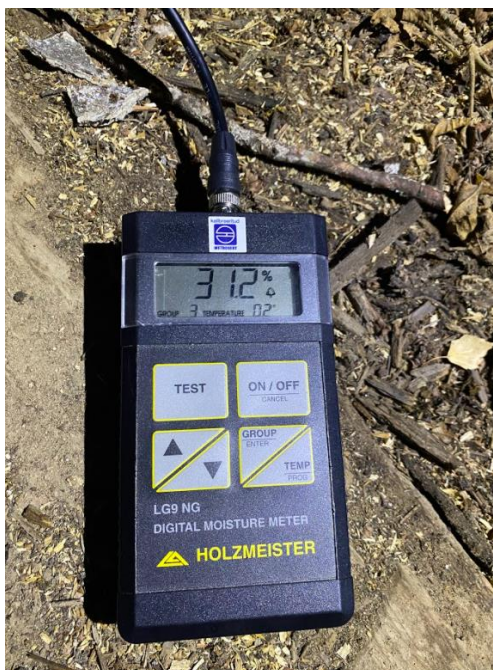
Joonis 3.25 Sadevetest kahjustada saanud vahelaetala puidu niiskuse sisaldus (autori foto)
