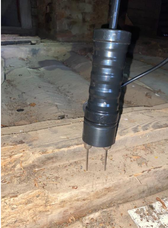
Joonis 3.23 Vahelaetala puidu niiskuse sisalduse mõõtmine (autori foto)
