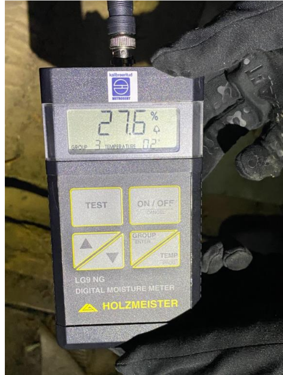
Joonis 3.24 Puidu niiskuse sisalduse seadme mõõtmistulemus vahelaetalal (autori foto)
