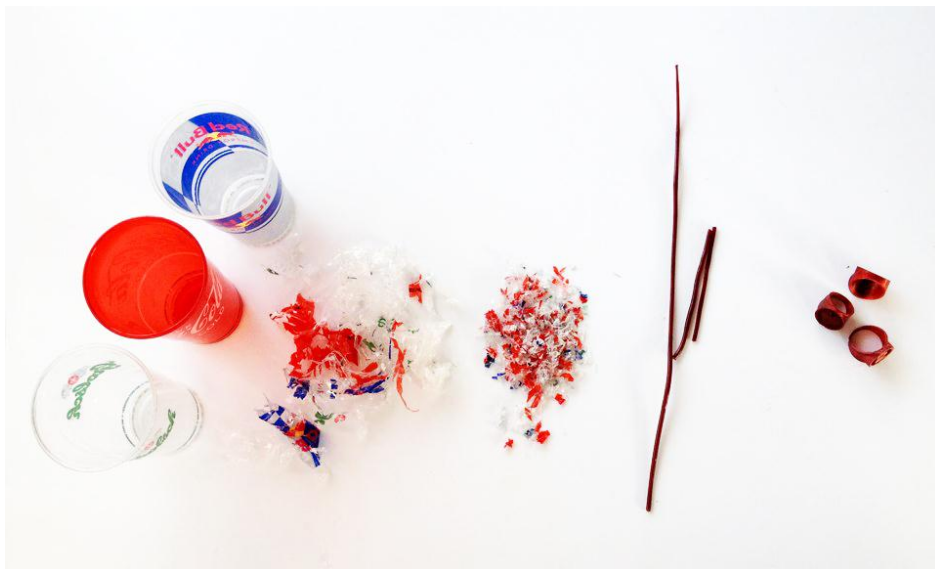
Joonis 10 PLA taaskasutus 3D printimisel. Paremalt on 3D prinditud sõrmuseid [20].
