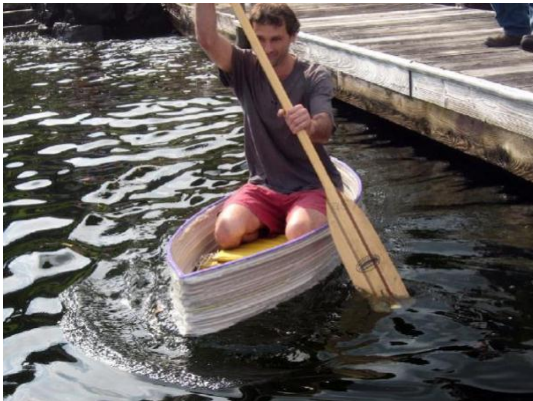
Joonis 16 3D prinditud plastpaat, valmistatud jahvatatud piimakanistritest [1].
