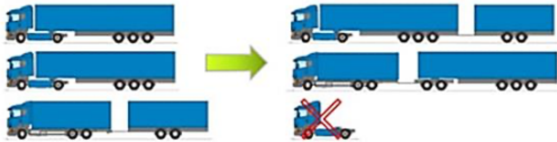
Joonis 8. EMS standardiseeritud veoste kasutusvõimalused HCTV autorongideks
