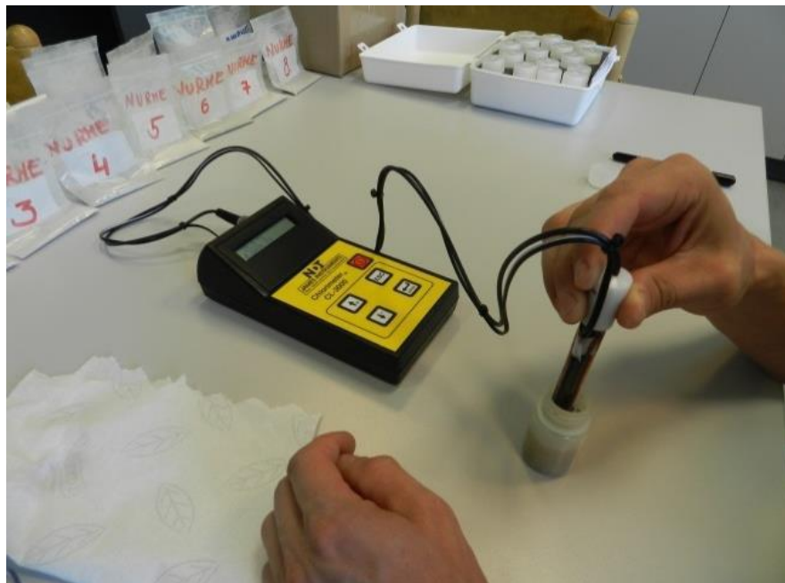
Foto 7. Betooni kloriidide sisalduse määramine seadmega C-CL-3000 Chloride Test System [29]
