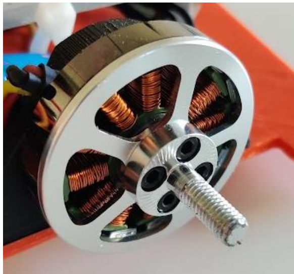
Joonis 3.6 Sõiduki harjadeta alalisvoolu mootor
