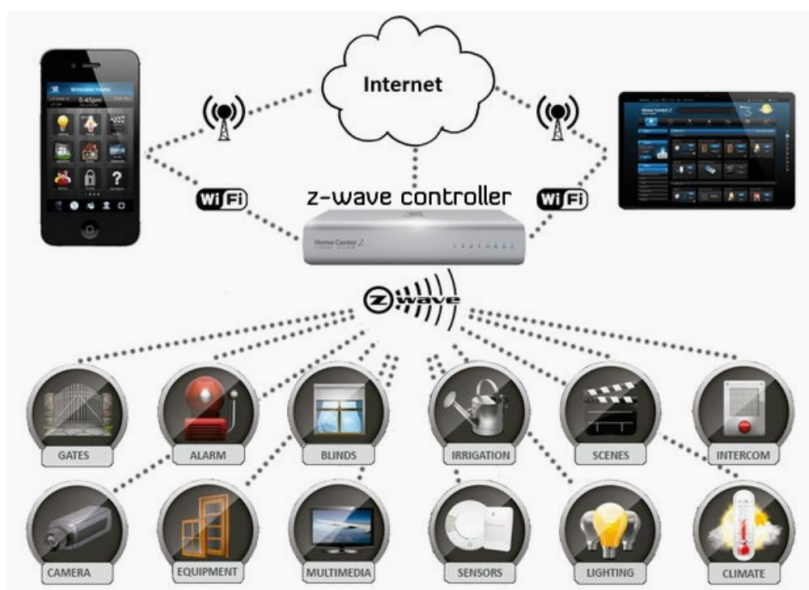
Joonis 2.4 Z-Wave standardil põhineva süsteemi juhtimine ning erinevad juhitavad seadmed [24]
