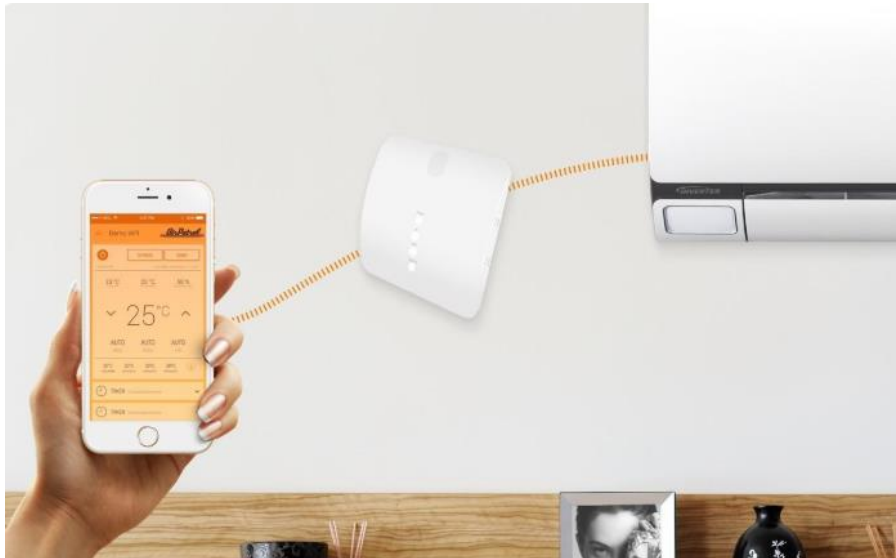
Joonis 5.8 AirPatrol - Nutikas õhksoojuspumba kontrolleri [170]
