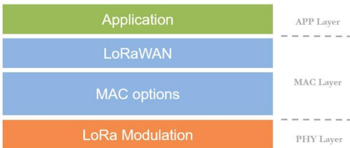
Joonis 3. LoRaWAN OSI mudel [12]
