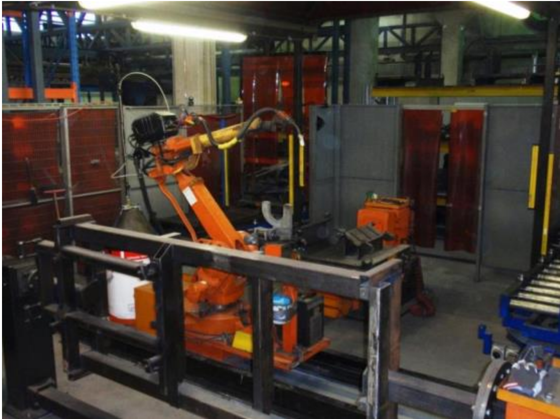
Sele 5.2. Ettevõtte robotkeevituse kompleks
