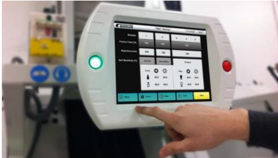
Sele 8.5. Inimese-masina-liidese seade puuetundliku ekraaniga [24]
