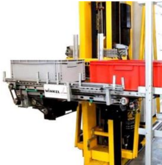
Sele 7.14. “Winkel” tõmbemehhanism y-telje lahenduses [12]
