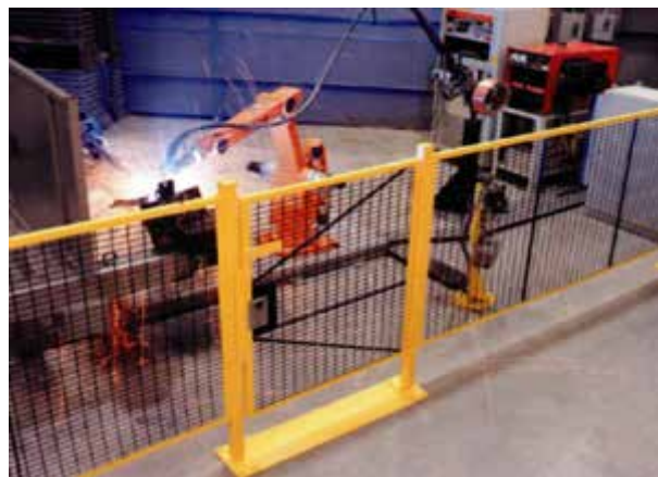
Sele 10.1. Keevitusroboti ala aiapiire ja uks [28]
