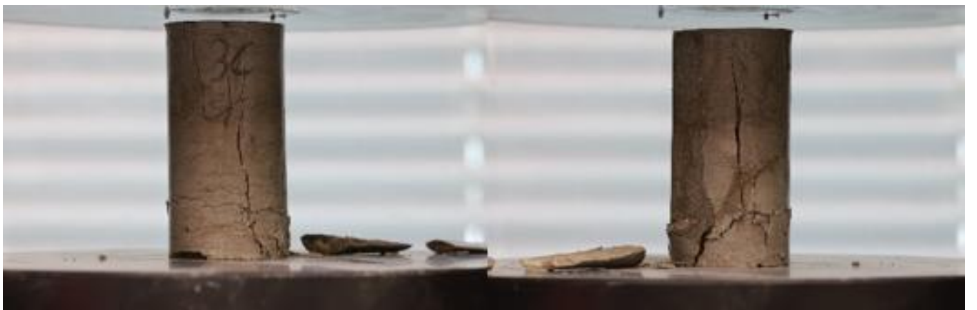
Joonis 14. M-grupi proovi 3C pildid eest ja tagant pärast katset.
