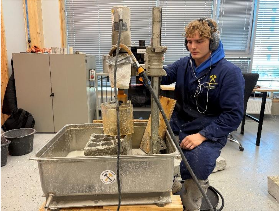
Joonis 7. Kivitükist puursüdamike välja puurimine.
