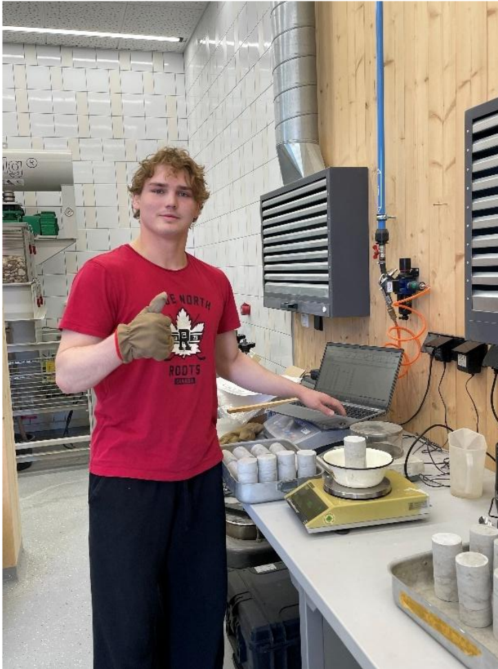
Joonis 10. Kuivatusahjust välja võetud proovide kaalumine
