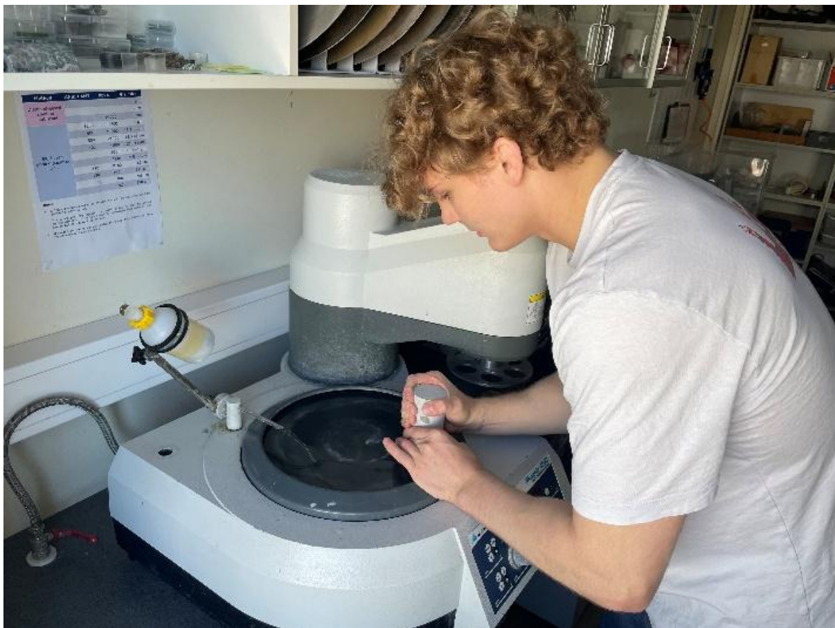
Joonis 9. Ebatasaste proovikehade otsade lihvimine.
