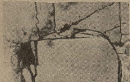
Фиг. 2. Дефекты в структуре сплавов после деформирования. Объяснения в тексте. \times 900 .
