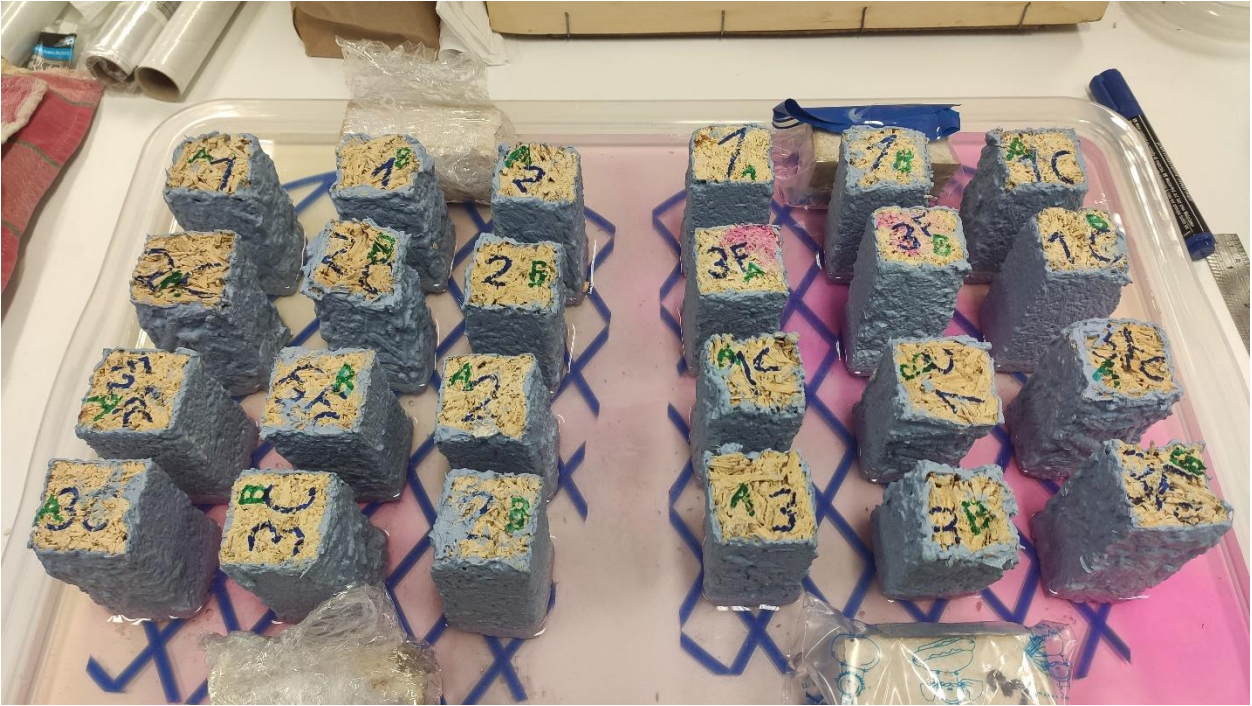
Joonis 17 Veeimavuse katse alustamine
