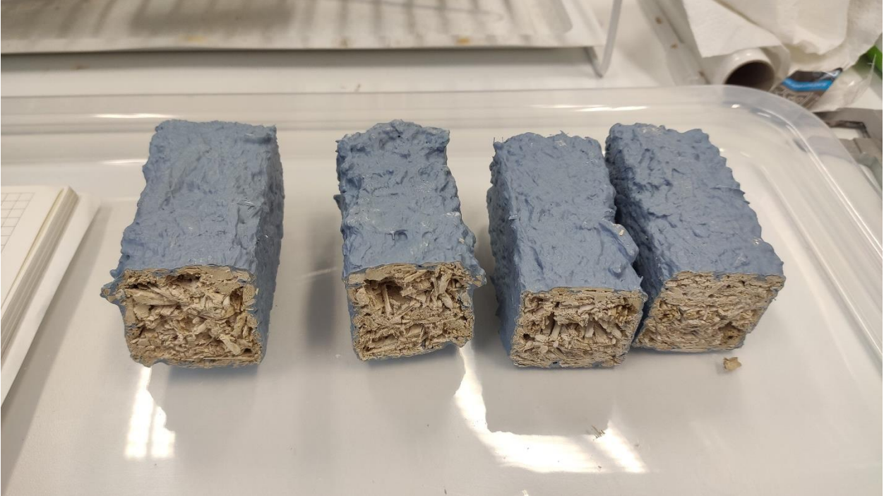
Joonis 16 hüdroisloeritud ja poolitatud katsekehad
