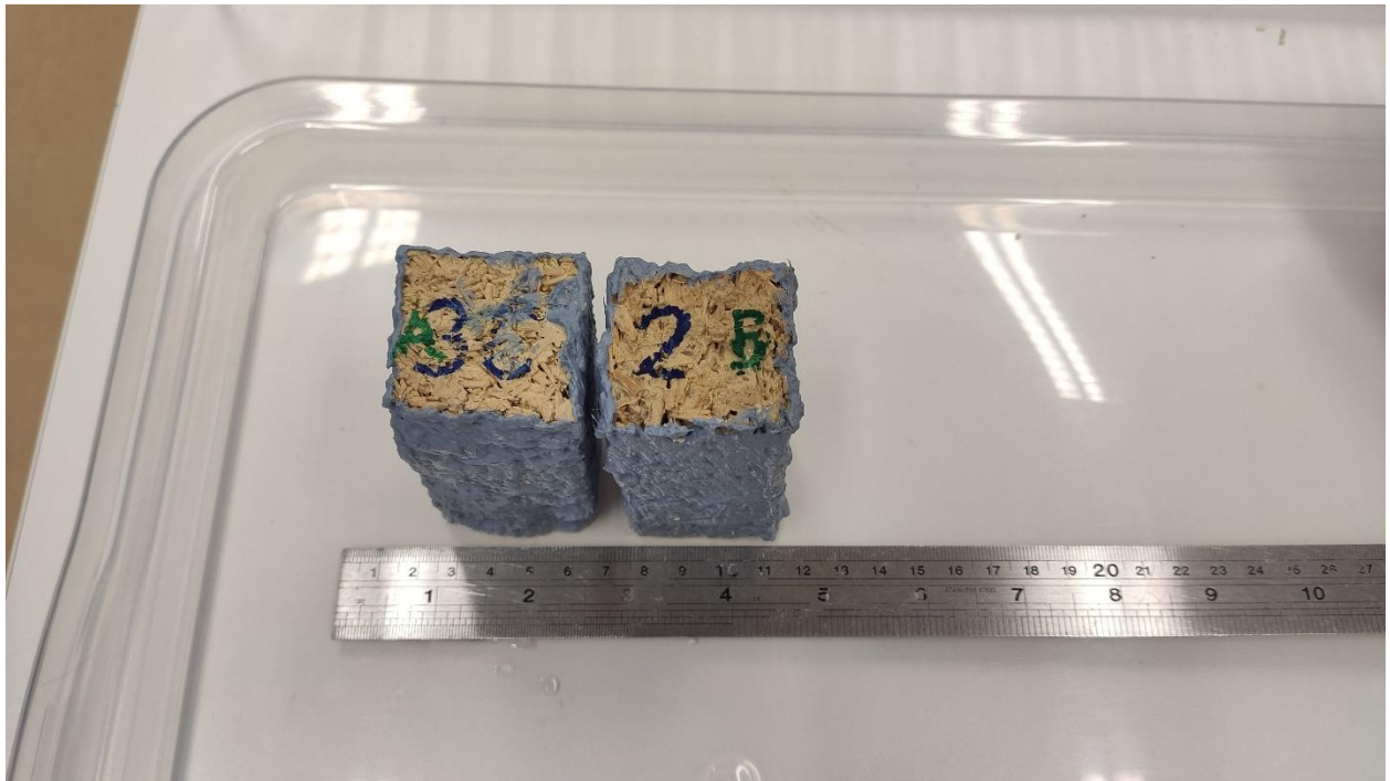
Joonis 23 veeimavuse katse läbimata ja läbinud katsekeha võrdlus
