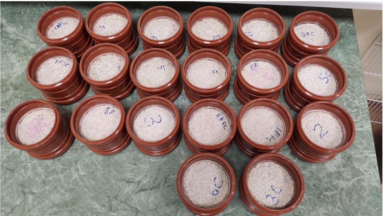
Joonis 25 Veeauru läbilaskvuse katsekehad peale katse sooritamist
