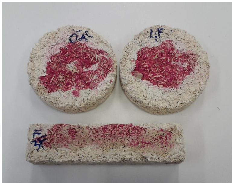
Joonis 13 Katsekehad, mida on hoitud kliimakambris niiskusel 87% (fenoolftaleiin 1%), Autor: Aime Ruus
