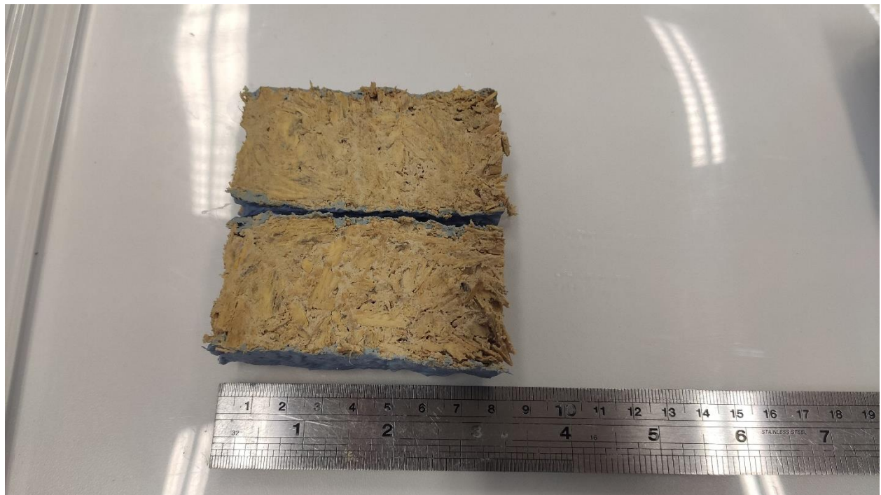
Joonis 24 Veeimavuskatse läbinud ja poolitatud katsekeha
