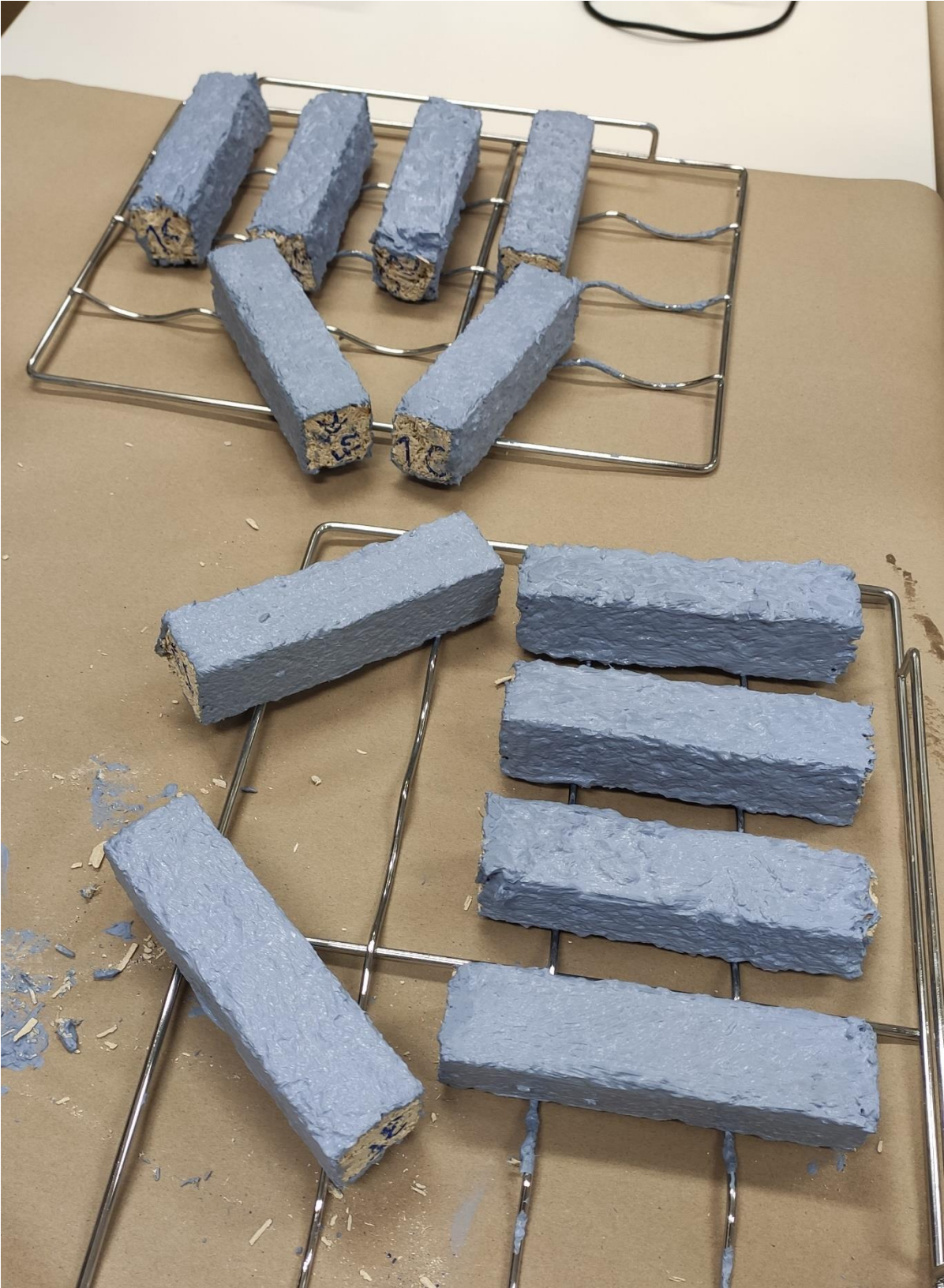
Joonis 15 katsekehade hüdroisoleerimine
