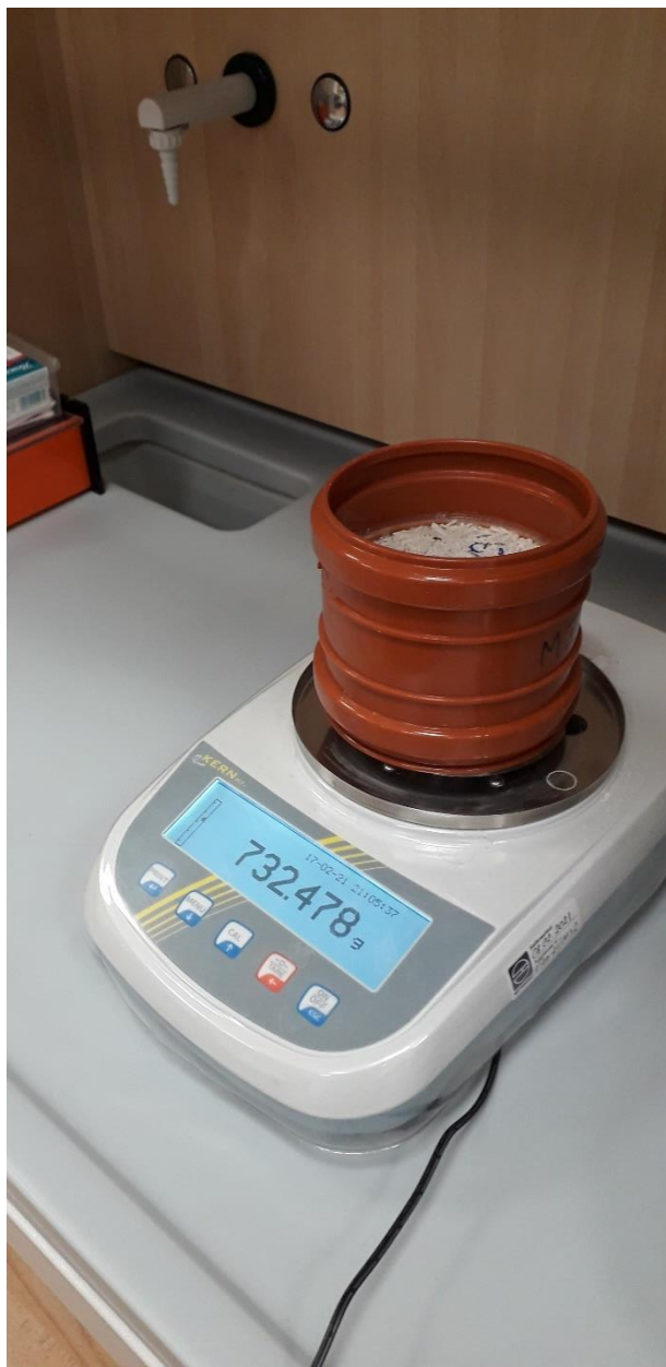
Joonis 19 Kaalumise difusioonikatsel Autor: Aime Ruus
