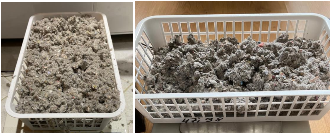
Joonis 36 Tselluvill enne uputamist (vasakul), tselluvill peale sisetingimustes kuivamist (paremal) (erakogu)
