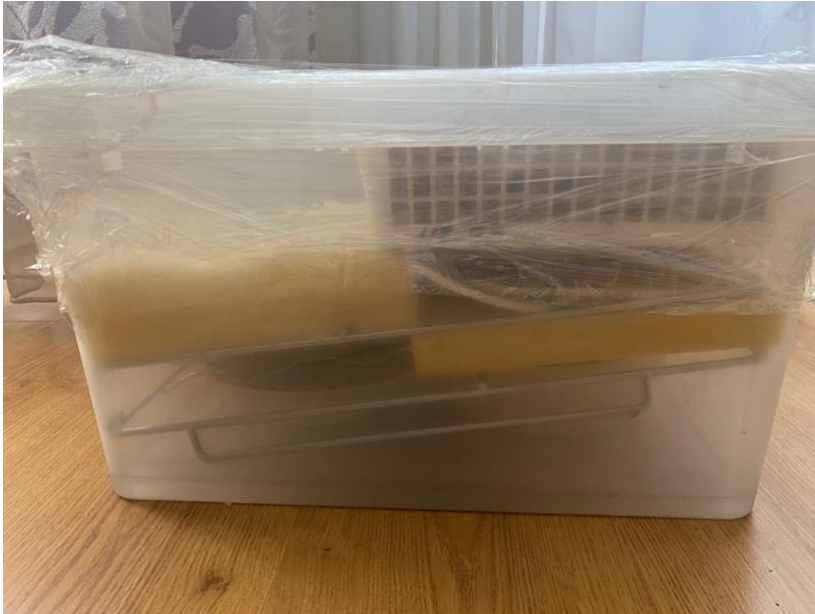
Joonis 10 Sorptsioonikatse tarvis kast külgvaates (erakogu)
