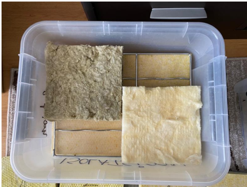
Joonis 8 Sorptsioonikatse tarvis kast pealtvaates (erakogu)
