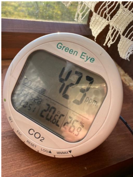
Joonis 12 Green Eye logger (erakogu)
