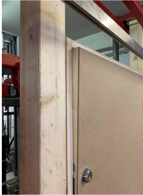
Joonis 10.2 Katseukse deformatsioon koormuse F_2 rakendamisel
