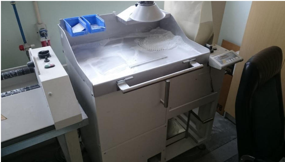
Joonis 9. Detailide puhastamise ja kasutatud materjali sõelumise töölaud Allikas: autori pildistatud
