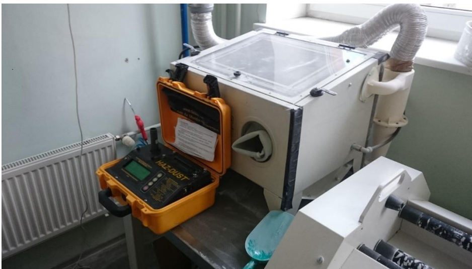
Joonis 10. Liivaprits detailide puhastamiseks Allikas: autori pildistatud
