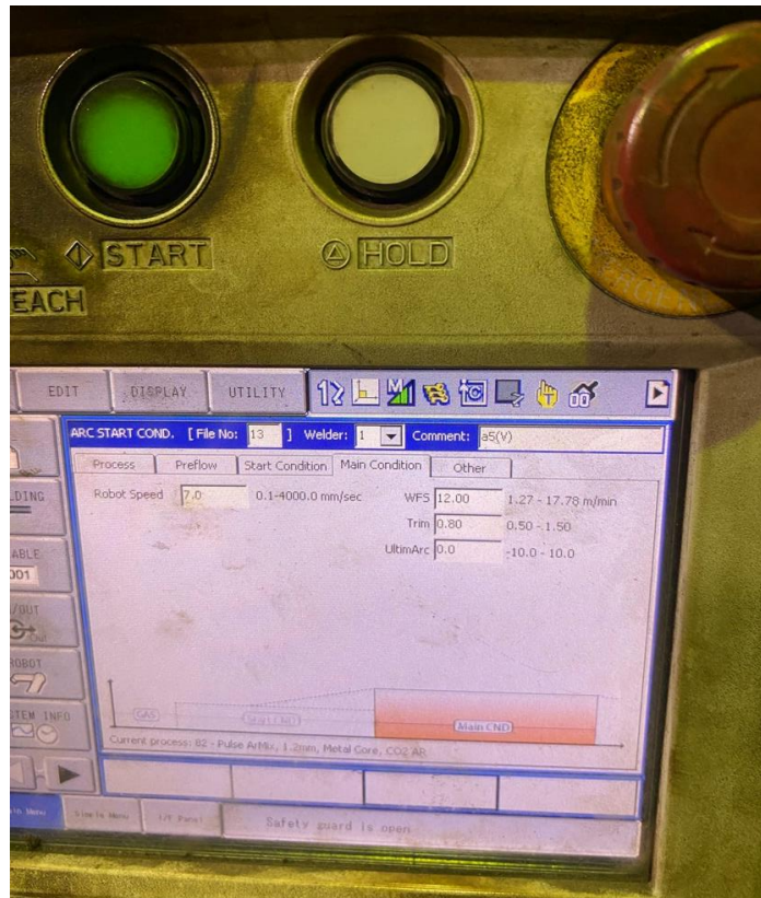
Joonis 4.6 Programeerimine. Keevitus parameetrite paigaldus
