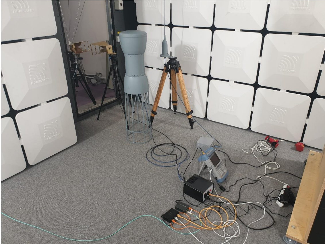
Joonis 17 Signaali vastu võtvate antennide asetus TTÜ varjestatud kambris.
