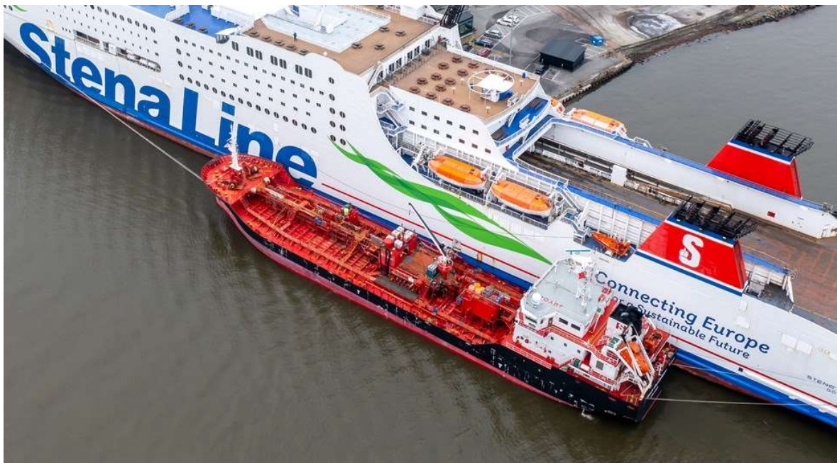
Joonis 22 Stena Germanica punkerdamine Göteborgi sadamas 23.01.2023. Allikas: Port Technology, 2023.
