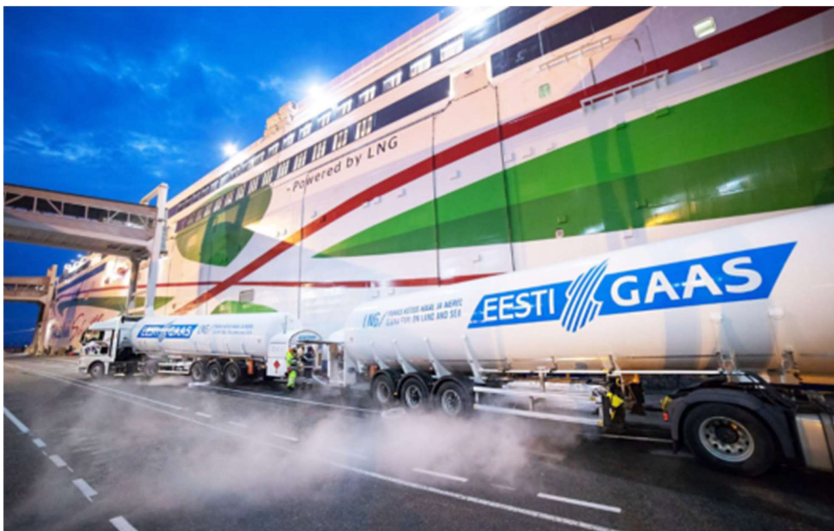
Joonis 7 MS Megastari punkerdamine veoautolt. Allikas: Eesti Gaas.
