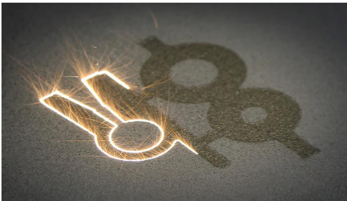
Joonis 1.6 SLM printimise protsess [26]
