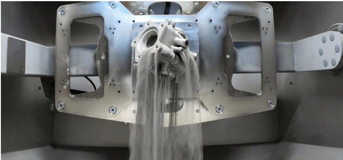
Joonis 1.7 Üleliigse pulbri eemaldamine peale lasersulatusprintimist [26]
