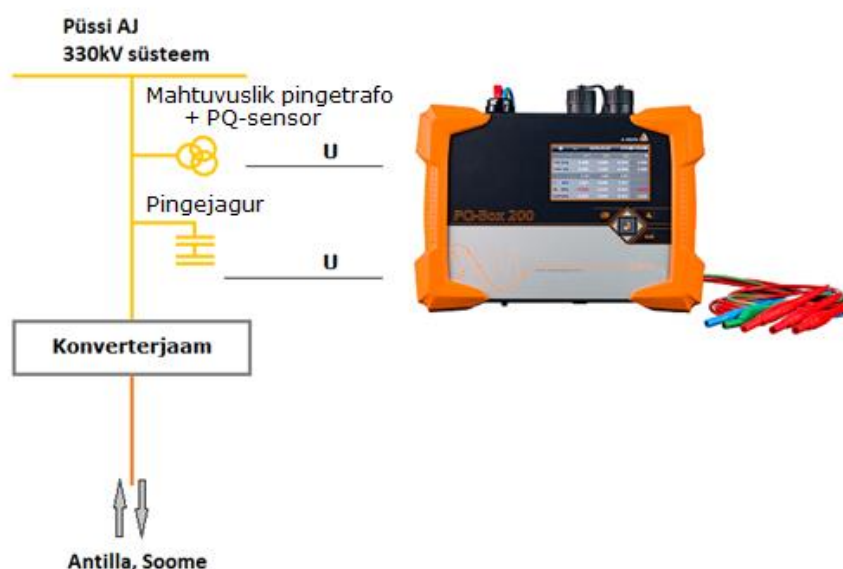
Joonis 2.5 Elektri kvaliteedi analüsaatori põhimõtteline ühendusskeem Püssi alajaamas Estlink 2 fiidris
