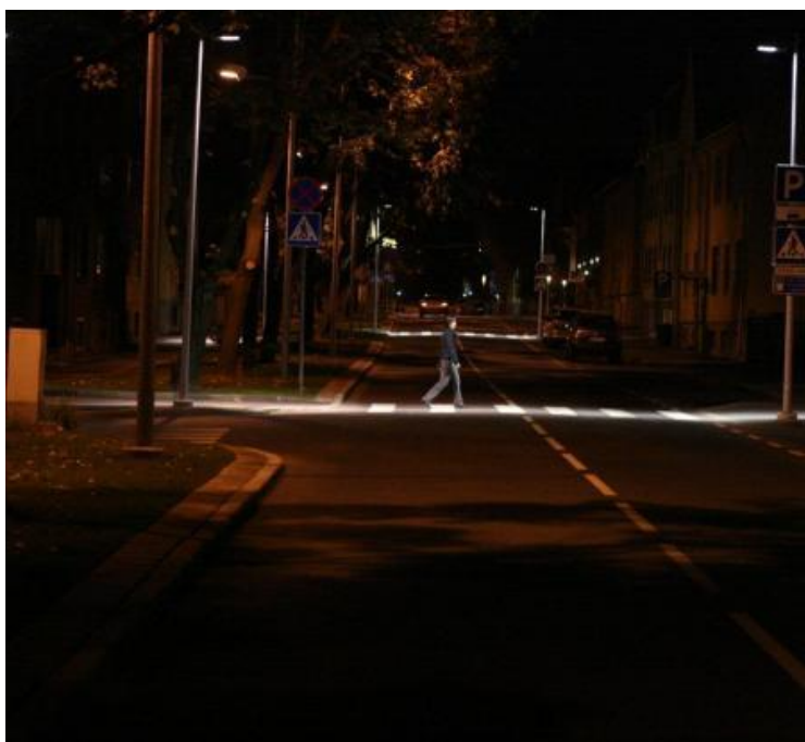
(Joonis 10. Lisavalgustusega ülekäigurada) Allikas: (K-H Energia konsult, 2017)
