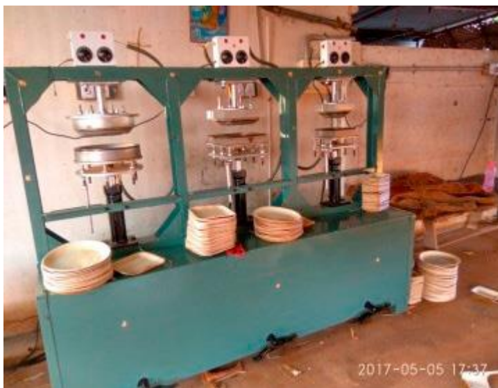
Joonis L2.3 Palmilehtedest nõude valmistamise pressid
