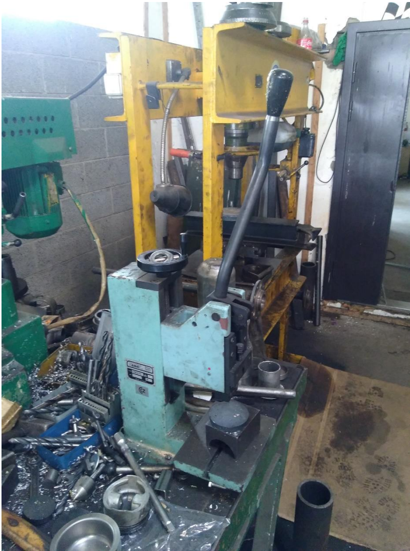
Joonis L3.3 Käsiress SEMET LPR 6/12 (esiplaanil) ja 40- tonnine hüdrauliline press (tagaplaanil)
