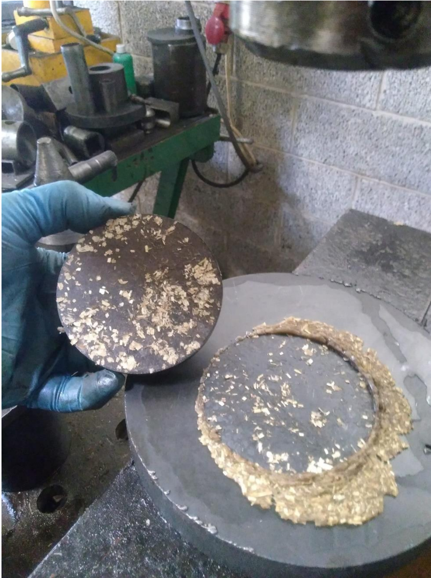
Joonis L3.5 40-tonnise hüdraulilise pressi all vormitud ebaõnnestunud materjaliproov
