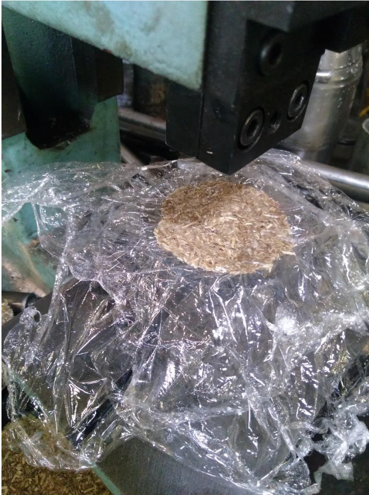
Joonis L3.4 Käsi pressi (SEMET LPR 6/12) all vormunud komposiitmaterjalinäidis
