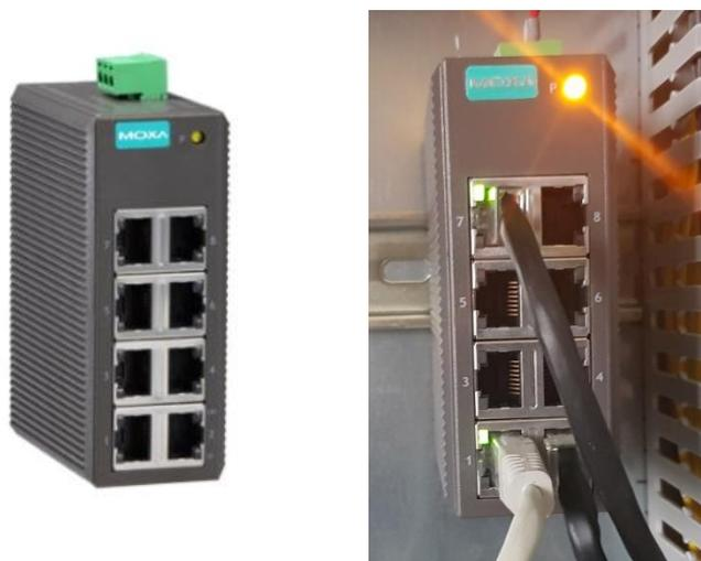
Рис. 3.2.5.1 Ethernet-коммутатор MOXA EDS-208 [30]
