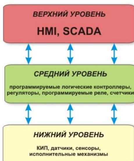
Рис.3.1 Стандартная структурная схема уровней АСУ ТП [5]
