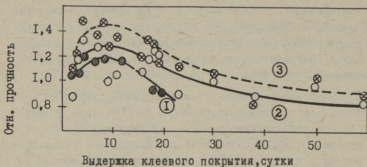
Фиг. 3. Относительная прочность при отслаивании НКП в зависимости от температуры его изготовления и выдержки клеевого покрытия при -15^{\circ}\text{C} : 1 - +40^{\circ}\text{C} ; 2 - +45^{\circ}\text{C} ; 3 - +55^{\circ}\text{C} .
