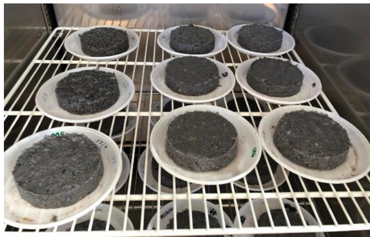
Joonis 2.2 Teine katse. Märjad katsekehad on asetatud kliimakambrisse koos alustega (Autori erakogu)
