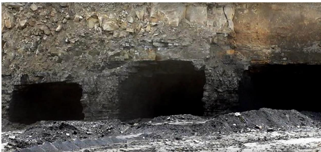
Joonis 8. Cat HW300 televäljamismasinaga raimatud ala. Allikas: https://www.youtube.com/watch?v=16nlWxzRQ8o&t=173s
