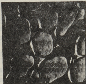
Фиг. 2. МЗС, шлифованный порошком М10 на эластичной основе.
