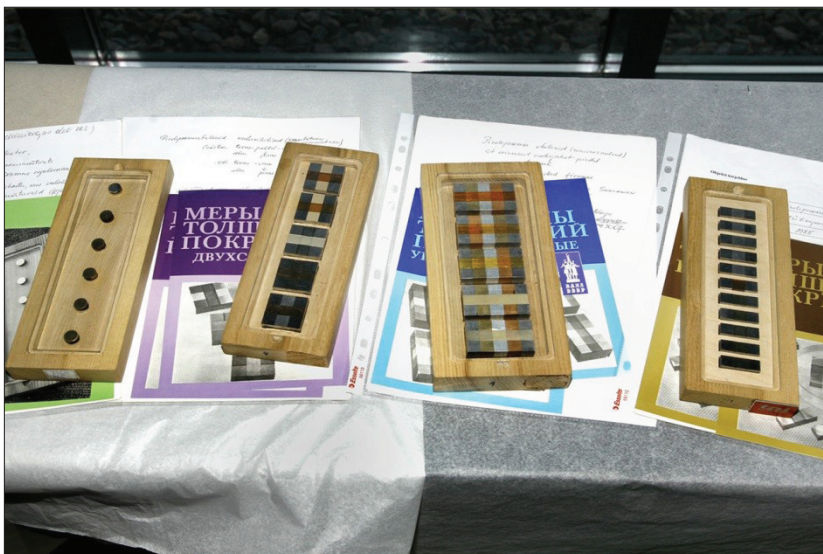
TPI Eksperimentaalis 1986. a valmistatud pindepaksusmõõtude (pindepaksustööetalonide) komplektid
