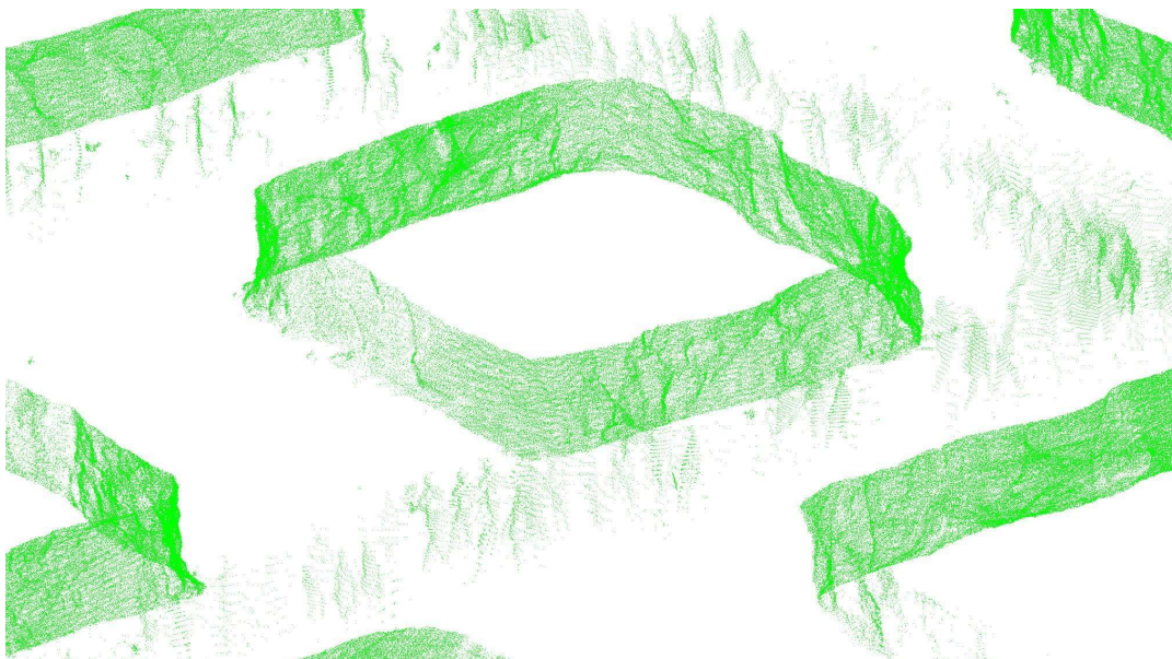
Joonis 6.15. GeoSLAM punktipilv, kus skaneerimisseadmele järgnenud inimfiguurid on skaneeritud pilve sisse
