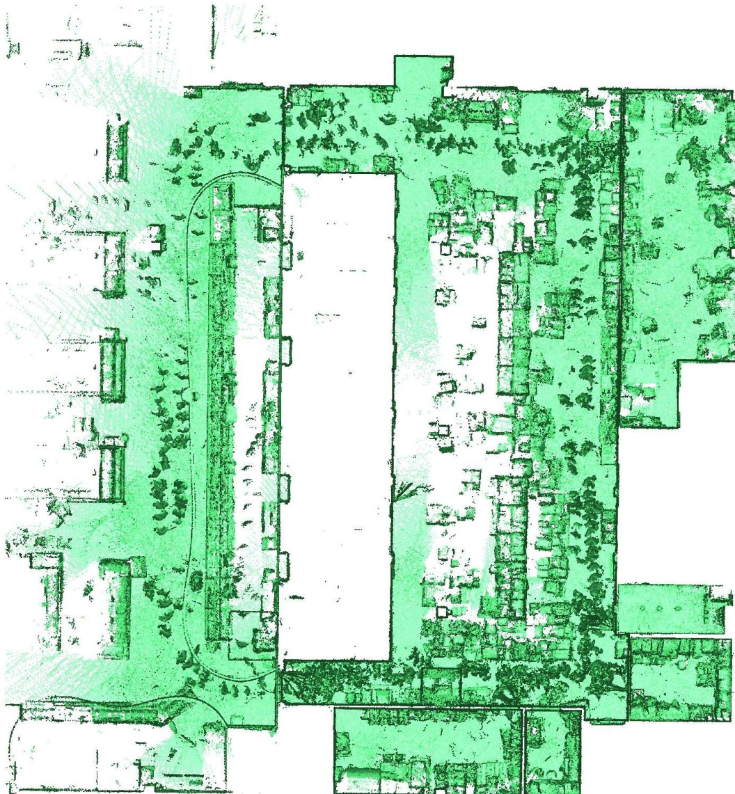
Joonis 6.24. GeoSLAM ZEB-REVO punktipilv lõikena lae pinnast madalamal, näha on kaubanduskeskuse sisemus, inventar, inimesed, kaubad. Seinad joonistuvad selgelt välja.
