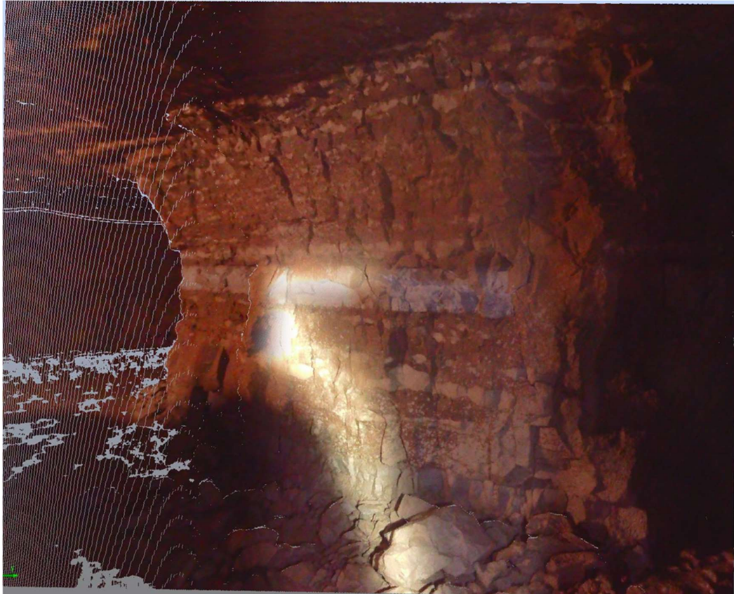
Joonis 6.12 Staatilise skänneriga tehtud värviline punkt pilv, kus selgelt eristub valge C/D vahekiht.
