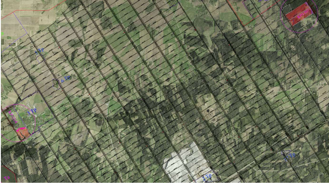
Joonis 6.21 Laserskaneerimisega 2018 ja 2019 saadud punktipilved ühtses andmebaasis koos maapealse situatsiooniga. Must võrgustik tähistab Estonia kaevanduse kambriplukke, sõõrides punasega tähistatult käesoleva töö raames erinevatel aegadel mõõdistatud kambriplokid. Ortofoto: Maa-amet 2019.
