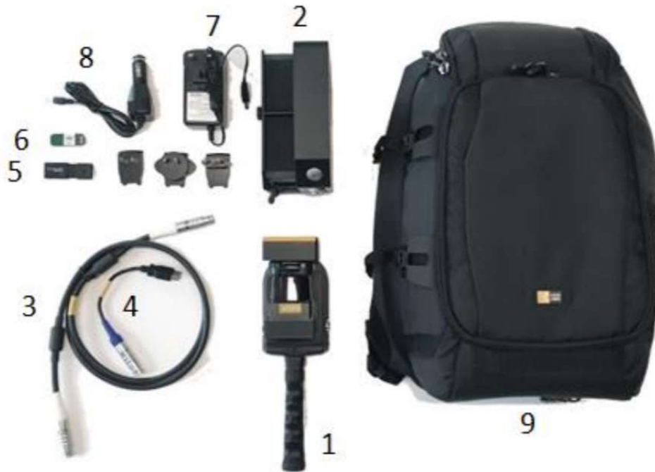
Joonis 5.2. GeoSLAM Zeb-Revo osad: 1 – käeshoitav laserskänner; 2 – andmete salvestaja; 3 – põhikaabel; 4 – allalaadimiskaabel; 5 – USB mälupekk; 6 – GeoSLAM Hub litsentsi võti; 7 – akulaadija ja adapterid; 8 – 12 V autoakulaadija; 9 – seljakott [21]
