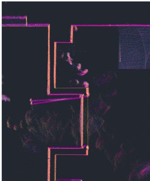
Joonis 6.41. GeoSLAM ZEB-REVO punktipilve lõige Maa-ameti hoone esimesest korrusest, fragment pealtvaates. Kollased sirged jooned on autoripoolsed seinakontuurid
