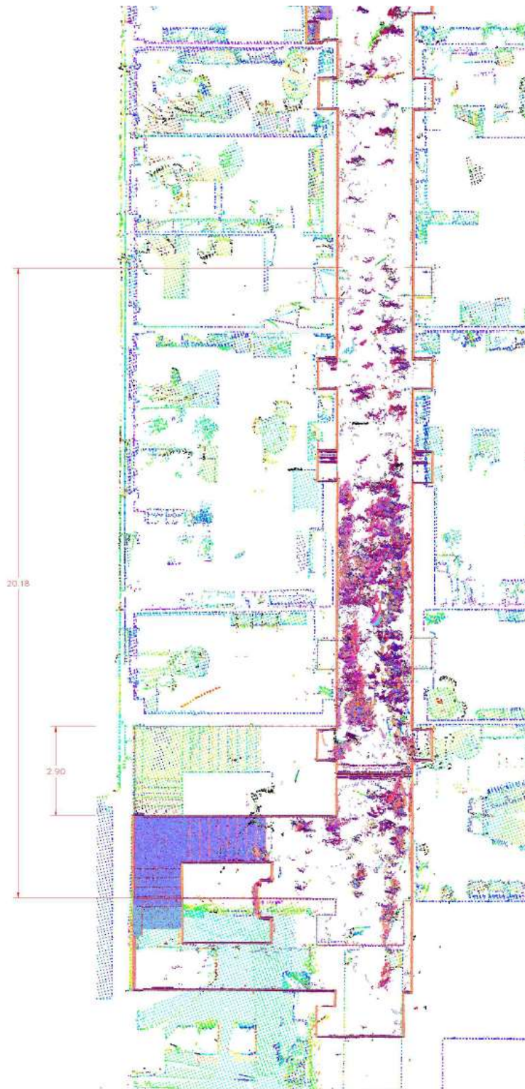
Joonis 8.11. Punaste toonidega GeoSLAM punkt pilve Faro punkt pilve kohal kolmandal korrusel. Nihe pilvede vahel on 2,9 m, erinevus tekib pika koridori keskosas
