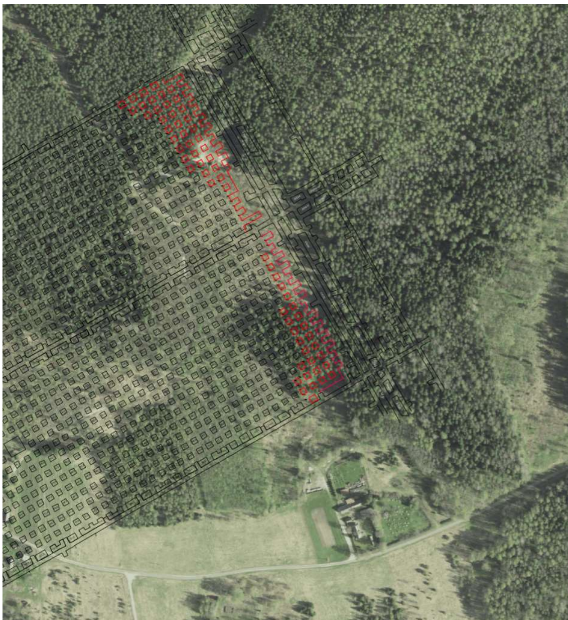
Joonis 8.6 Maa-aluse kaevanduse kambrite ja tervikute asukohta maapealsete objektide suhtes (mustaga kaevandatud osa, punasega edasiseks kaevandamiseks planeeritud osa). Ortofoto: Maa-amet 2019.
