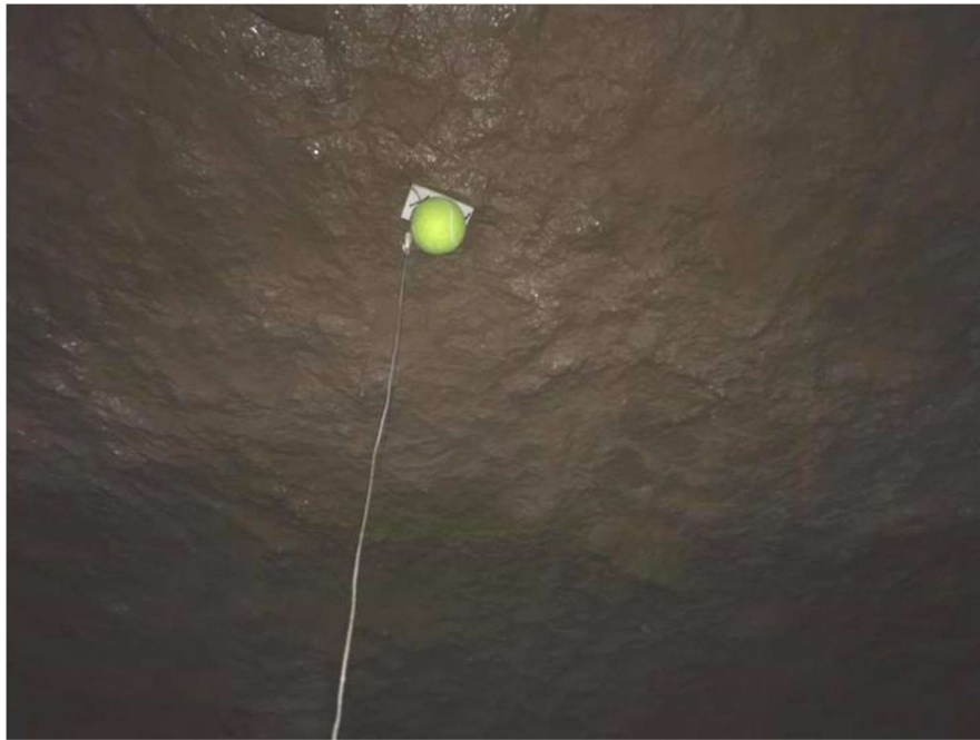
Joonis 6.4. Laserskaneerimise orienteerimiseks kasutatud siduspunktid, mis on riputatud markšneideri käikude koordineeritud laepunktidesse
