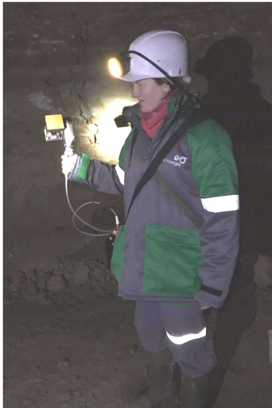
Joonis 5.1. Autor GeoSLAM ZEB-REVO käsiskänneriga Estonia kaevanduses
