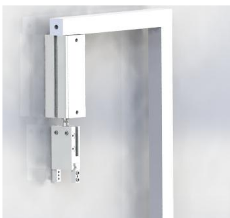
Sele 0.1.1. Trükkplaadilt tumbleri eemaldamise seadme mudel.
