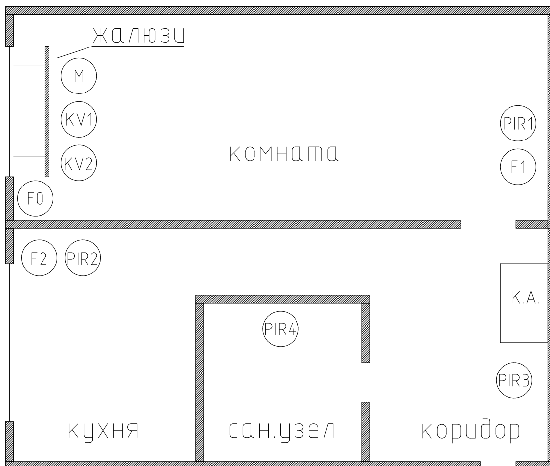
Рисунок 4. Расположение датчиков и исполнительных механизмов (фото автора)
