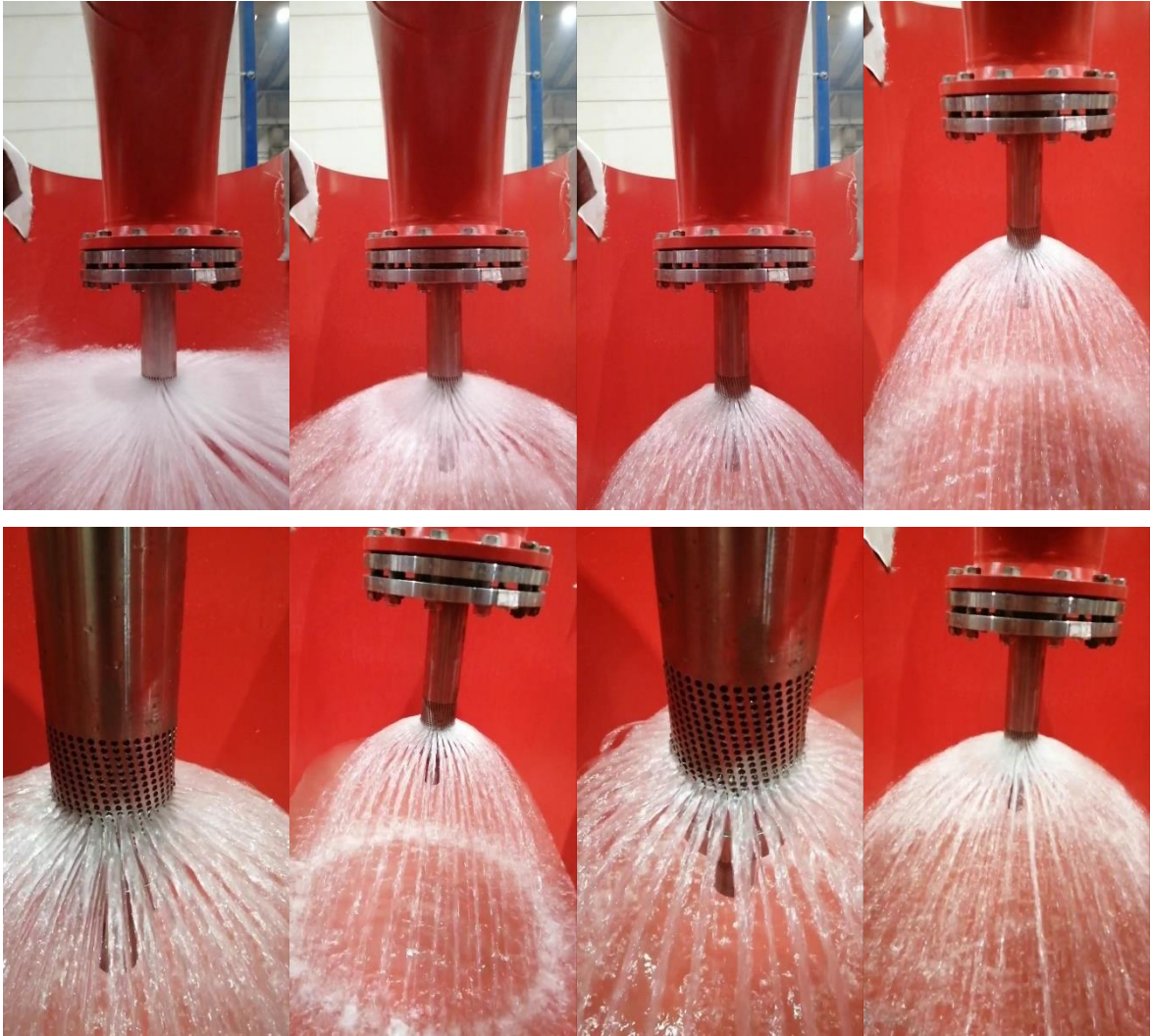
Joonis L1.2 Vedrupeaga pihustipea katsete pildid vasakult ülevalt 28., 29., 30., 47., 85., 160., 220. ja 230. sekundil
