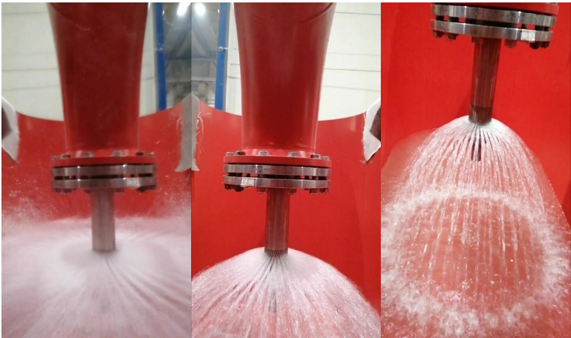
Joonis 5.5 Vedrupeaga pihusti katse tulemused esimesel 31 sekundil
