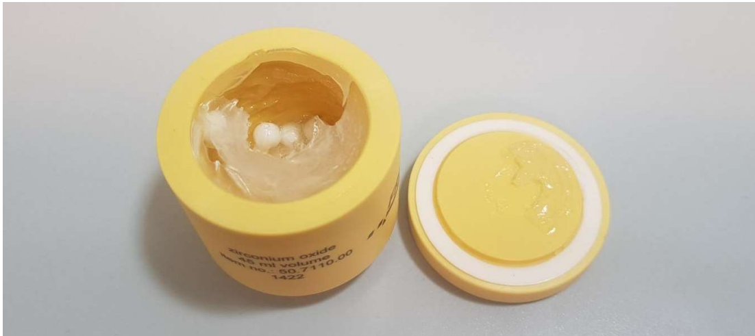
Joonis 2.8 MOF-i geel koos kuulikestega jahvatusanumas
