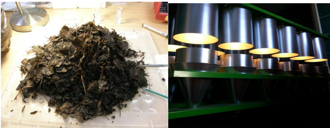
Joonis 4. Varisest makro-, megafauna välja selekteerimine ja mesofauna ekstraheerimine Tullgreni lehrtrite süsteemis ja (Karen Siltsi isiklik pildikogu, 2012)
