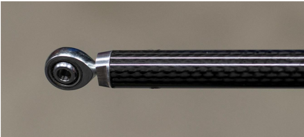
Joonis 1.4 Tudengivormeli FEST20 süsinikust roolivarras koos torulõpuga [11]
