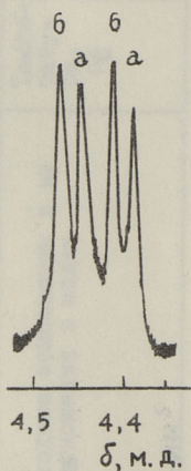
Рис. 2. Часть спектра ^1\text{H} ЯМР в ДМСО- d_6 (ММАА:СН 3 СООН= 1:0,1, 1 час при 80 °С).
