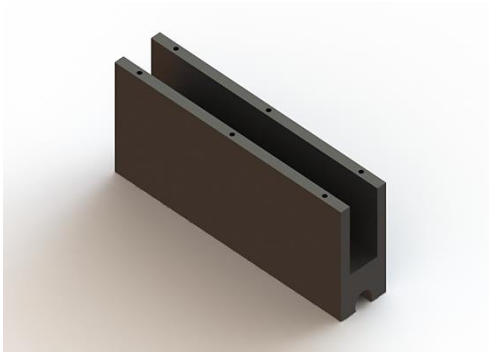
Sele 5.9 Modifitseeritud etteandemehhanismi jalg
