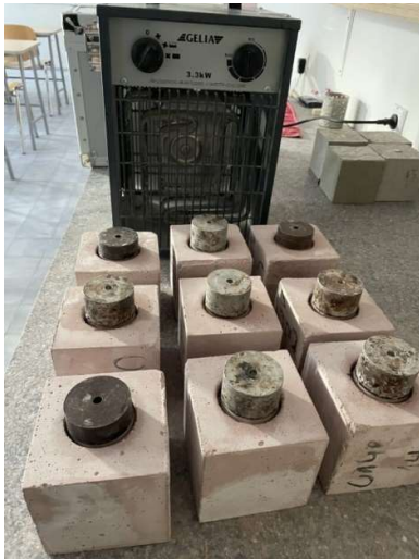
Foto 8. Katsekehade kuivatamine puhuriga. Foto autori erakogust.
