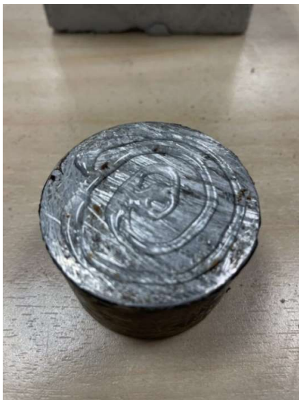
Foto 7. Epoksiidliimi kandmine metallsilindrile. Foto autori erakogust.
