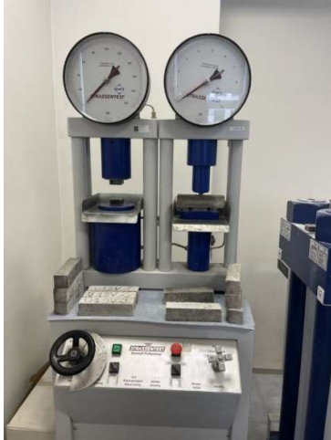
Foto 6. Paindekatskehade katsetamine pressiga. Foto autori erakogust.
