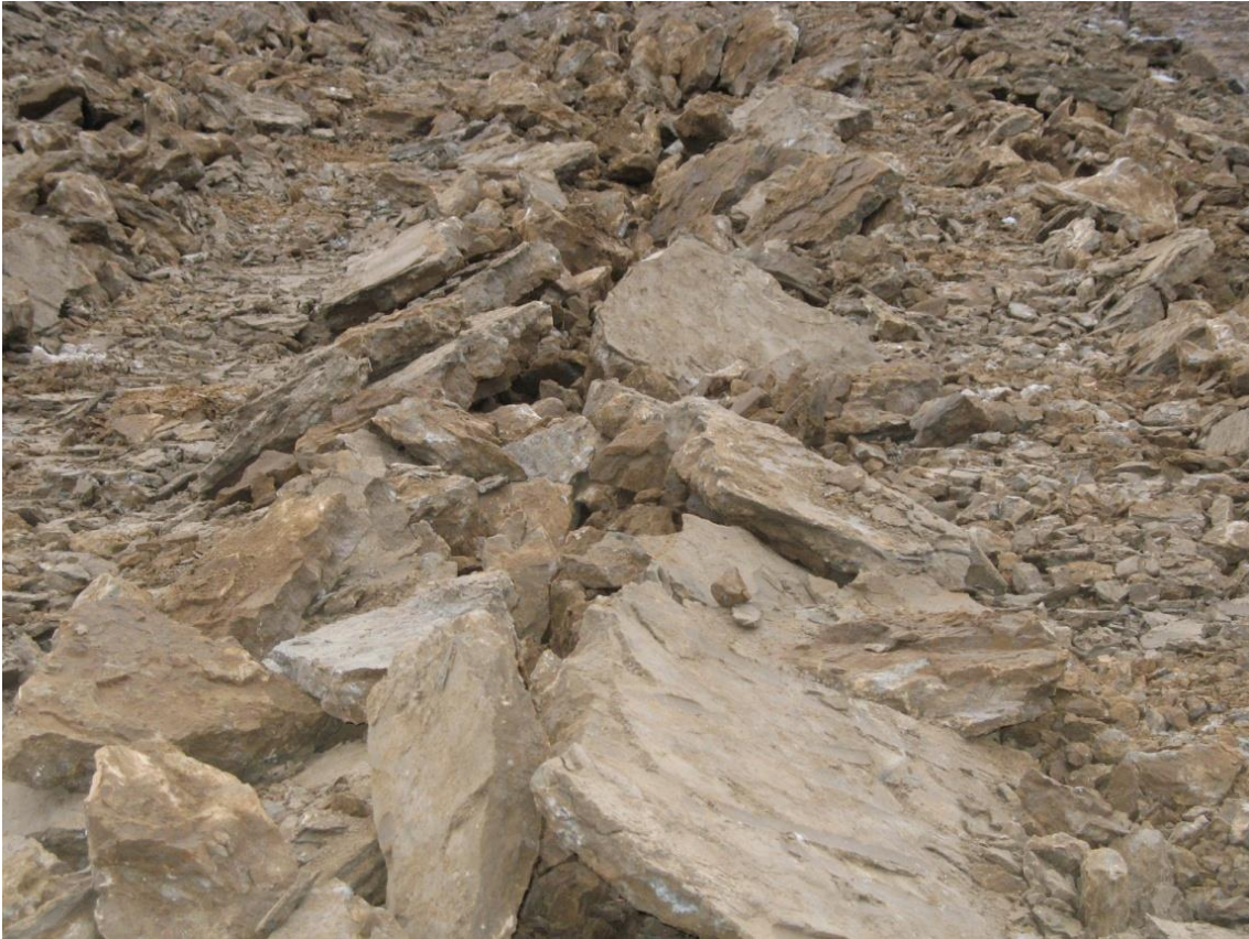
Joonis 7-1 Buldooseriiga raimatud põlevkivi
