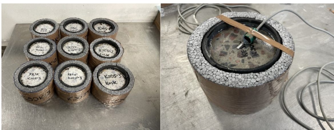
Foto 2.14 Katsetamiseks valmistatud katsekehad ja temperatuurianduri paigutus. Erakogu
