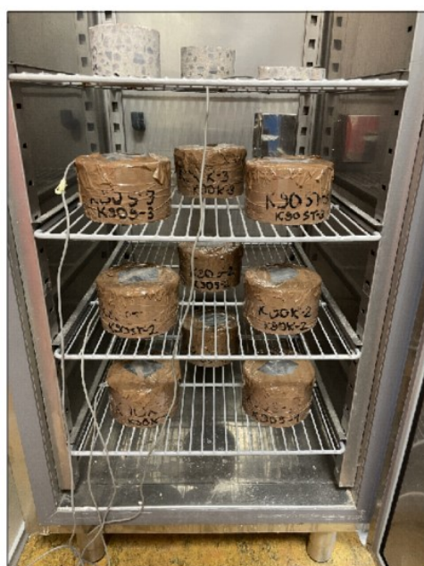
Foto 2.16 Katsekehade ja temperatuuriandurite asetused kliimakambris. Erakogu
