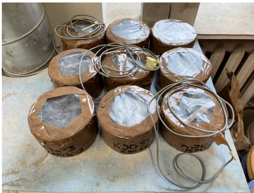
Foto 2.15 Valmis katsekehad kliimakambrisse asetamiseks. Erakogu
