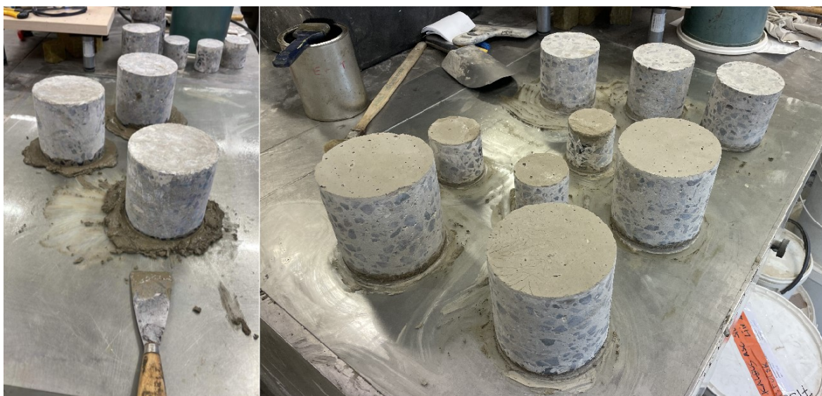
Foto 2.9 Proovikehade tasandamine aluminaattsementmördiga. Erakogu
