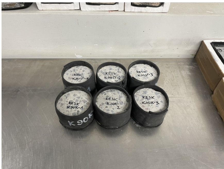
Foto 2.13 Kummiümbrisega külmakindluse katsekehad. Erakogu
