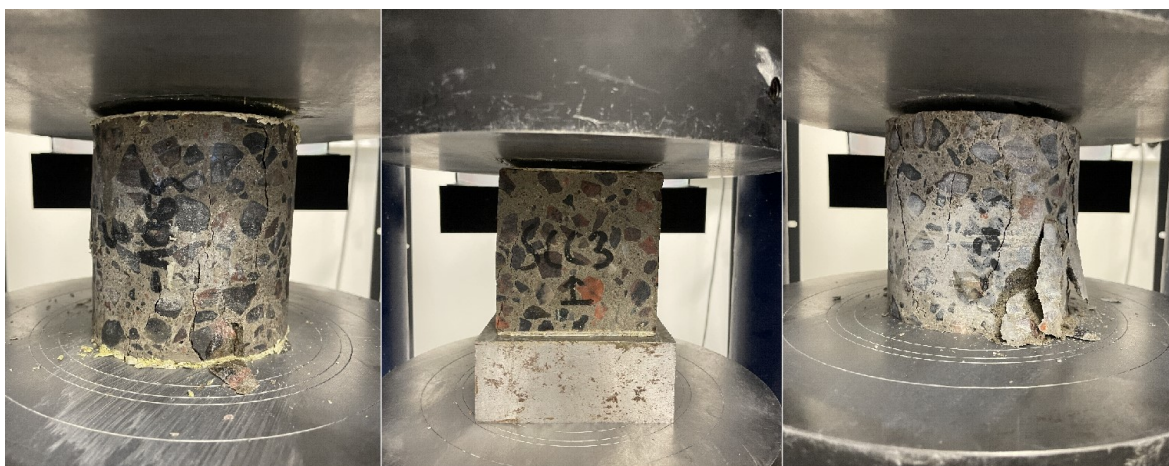
Foto 2.12 Survetugevuse katsekehade purunemispildid. Erakogu
