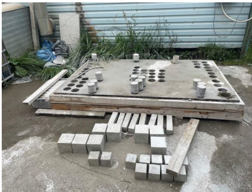
Foto 2.1 Katseplaadist puuritud proovikehad ja nende asukoht 2021. aastal [75]
