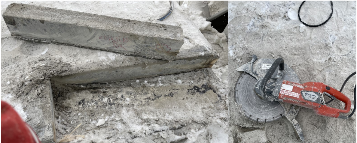
Foto 2.8 Kuubikujuliste katsekehade lõikamine ja kasutatud ketaslõikur. Erakogu
