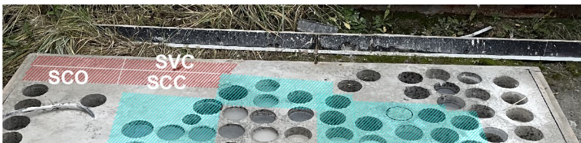
Foto 3.1 Kuubikujuliste katsekehade asukoht katseplaadil. Erakogu
