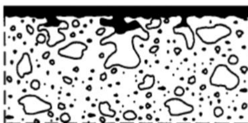
Joonis 4.4 Standardist EVS-EN 1504-2:2007 Kujutlik skeem pidevast kihist betoonpinnal [14]
