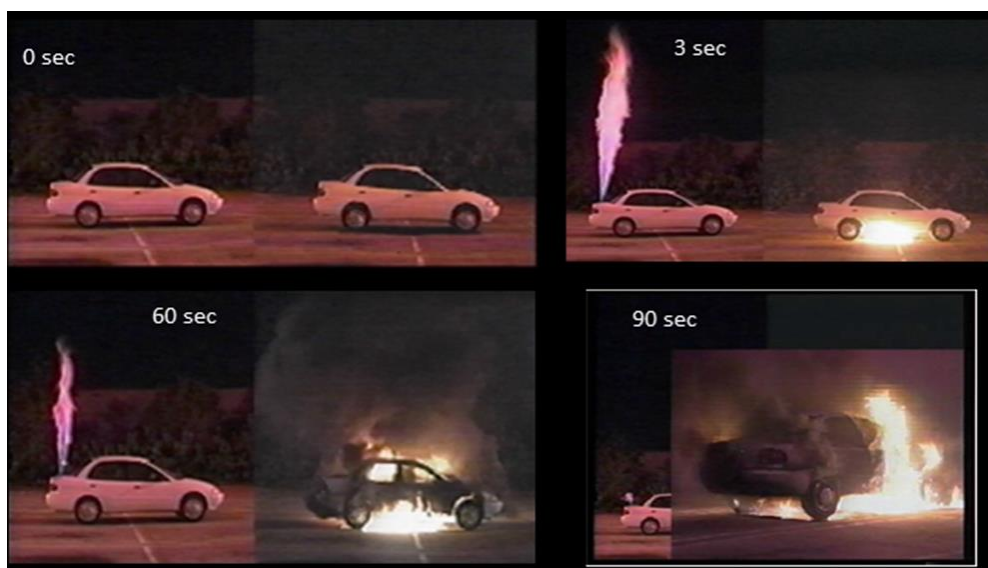
Joonis 3.2 Vesinikul (vasakul) ja bensiinil (paremal) sõitva auto kütuse põlemise simulatsioon [59].
