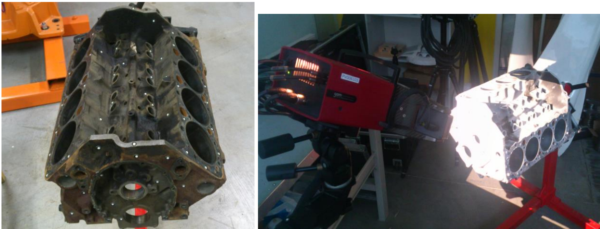
Sele 3.1 3D skännimiseks ettevalmistatud mootoriplokk ja skanneerimine Atos'ega
