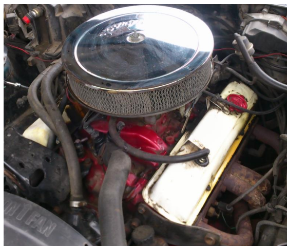
Sele 1.1. Võistlusauto mootor. 5 liitise töömahuga LG4
