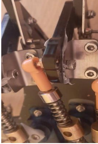
Joonis 28. Keskmise sõrme polt läheb läbi mutriava.
