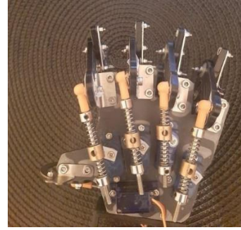
Joonis 9. Robotkäsi ülevalt vaade, step mootori jupp üleval pool.
