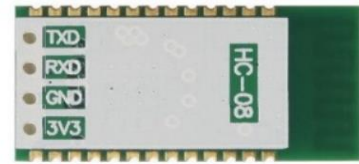
Joonis 71. Bluetooth moodul altvaade (ühendused). [25]
