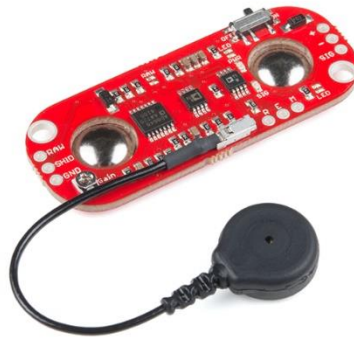
Joonis 13. MyoWare lihassensori komplekt. [21]
