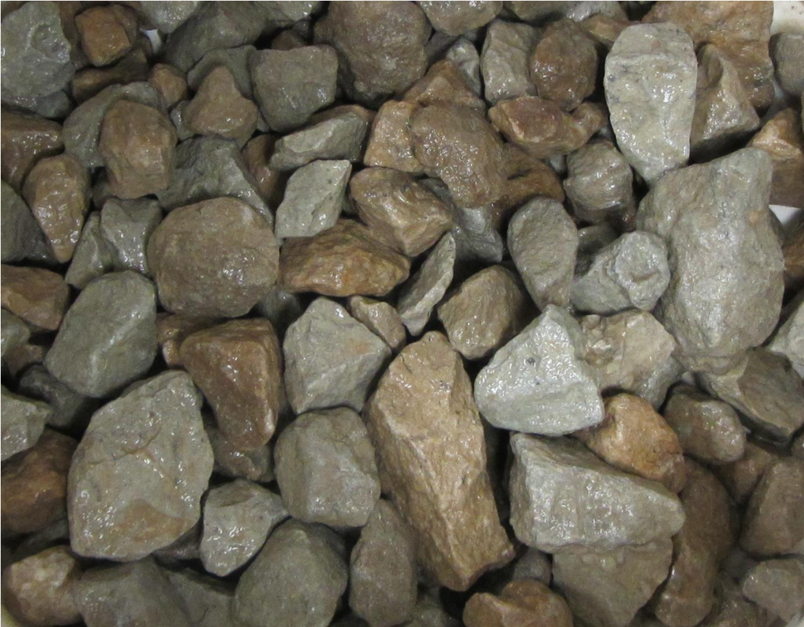
Joonis 19. Vesiklaasi lahusega(0,2 %) kaetud aheraine kohe peale segamist
