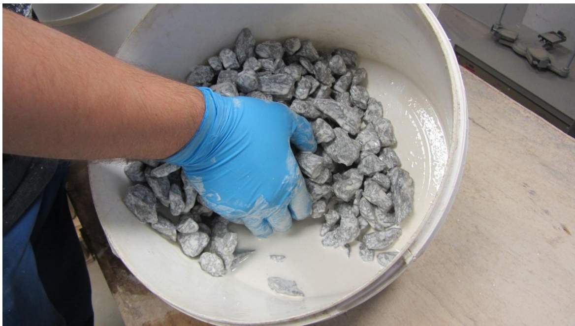
Joonis 17. Immutamine üleküllastumisega lubja puhul
