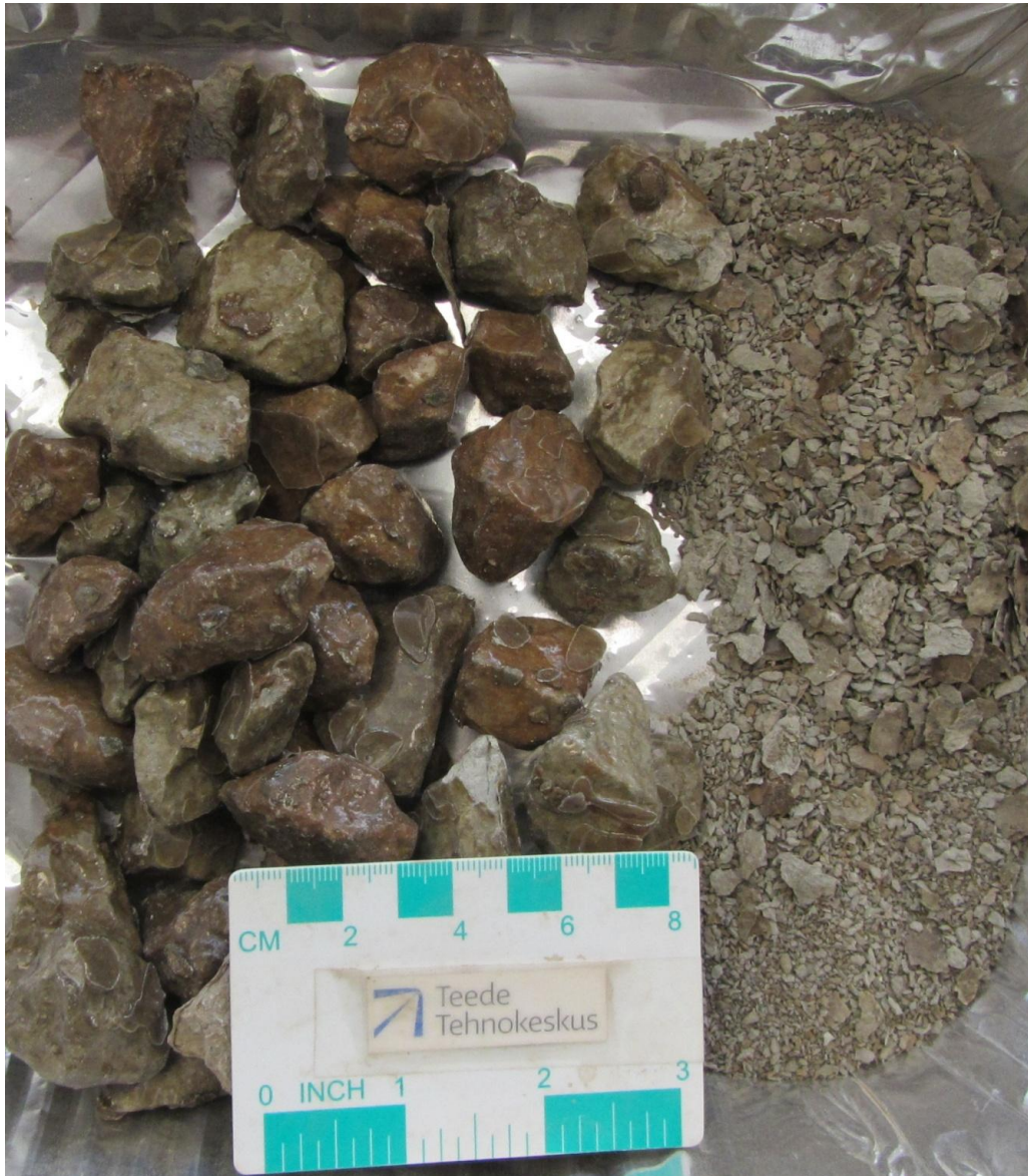
Joonis 25. Aheraine üleni kaetud epoksüvaiguga peale külmutuskatset soolalahuses. Parem pool pilti on alla 8 mm tükisuurusegamaterjal
