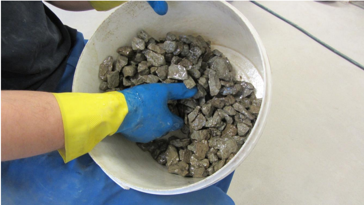
Joonis 21. Referentskillustiku käsitsi katmine epoksüvaiguga
