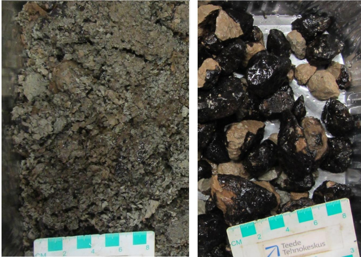
Joonis 24. Aheraine peale külmakindluse katset 1%-ses NaCl lahuses. Vasakul pool pildil on purunenud materjal enne 8 mm sõelast läbi pesemist, paremal peale pesu
