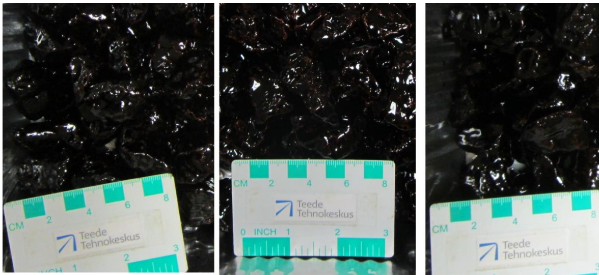
Joonis 15. Aheraine visuaalseks hindamiseks tehtud proovid. Põlevkivibituumeni kogused alates vasakult: 2,3%; 2,6%; 3,0%
