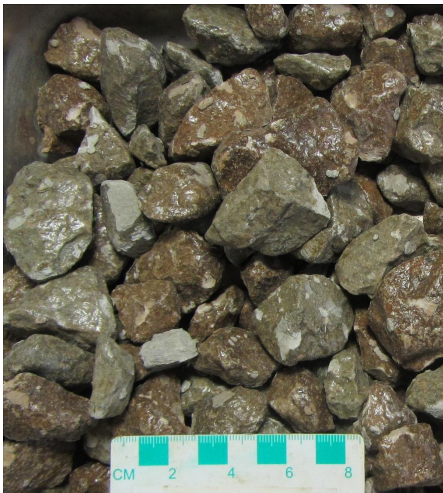
Joonis 23. Güraatortihendiga töödeldud epoksüvaiguga kaetud aheraine
