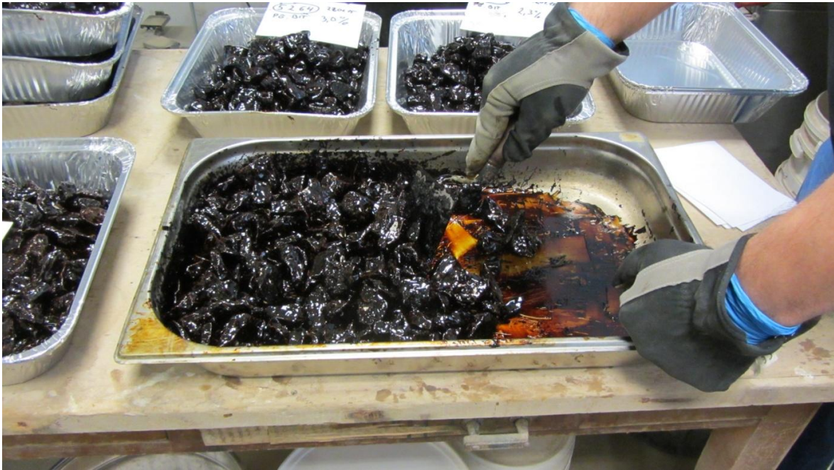
Joonis 8. Segamismeetod emulsiooni ja põlevkivibituumeni puhul. Pildil segamine põlevkivibituumeniga
