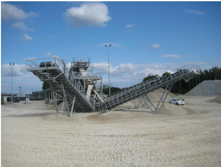
Joonis 2. Estonia kaevanduse aherainekillustiku tootmisel kasutatavad lintkonveierid [12]
