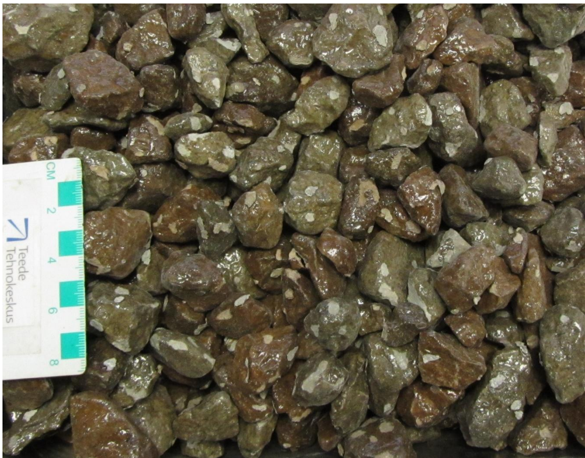
Joonis 22. Epoksüvaiguga kaetud aheraine, peale kuivamist lahti murtud
