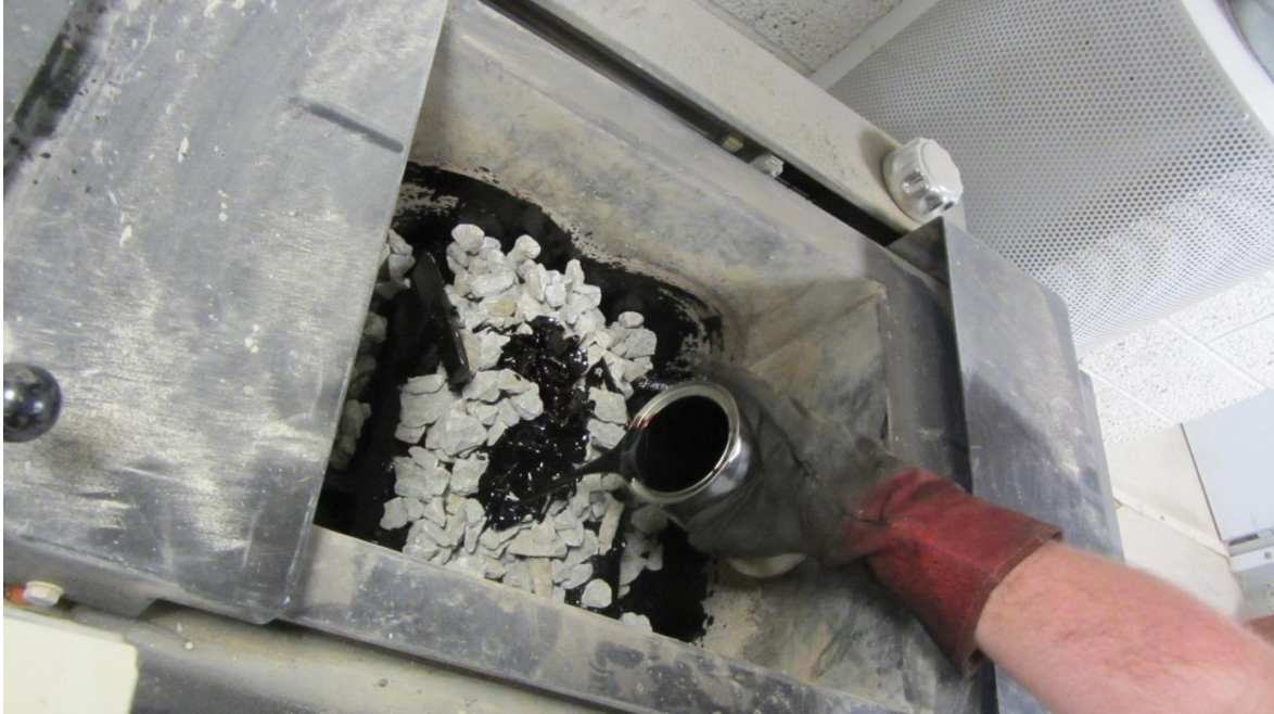
Joonis 12. Põlevkivibituumeni lisamine referentskivile seguris SRC. Emulsiooniga toimus lisamine ja segamine analoogselt.[5]
