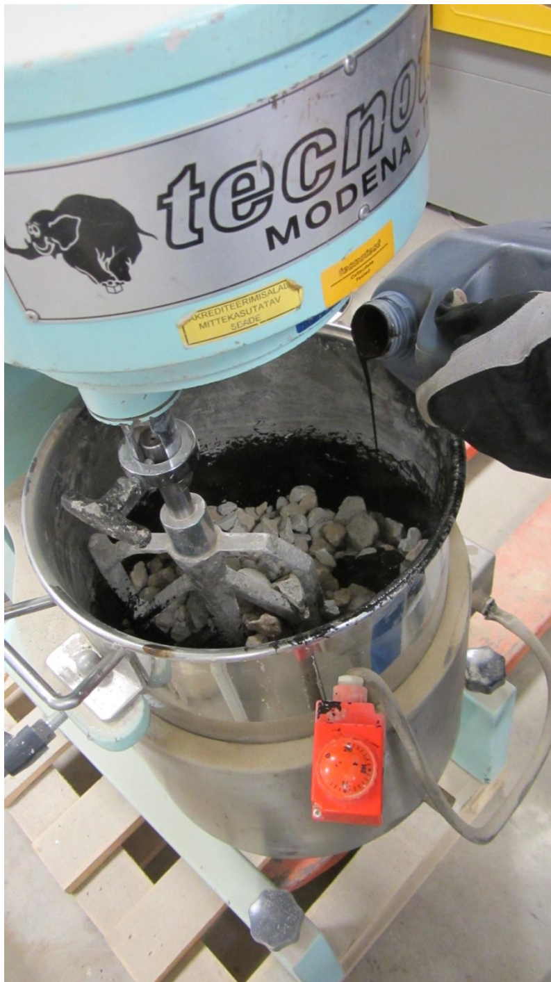
Joonis 11. Bituumenemulsiooni lisamine sugurisse Tecnotest [5]
