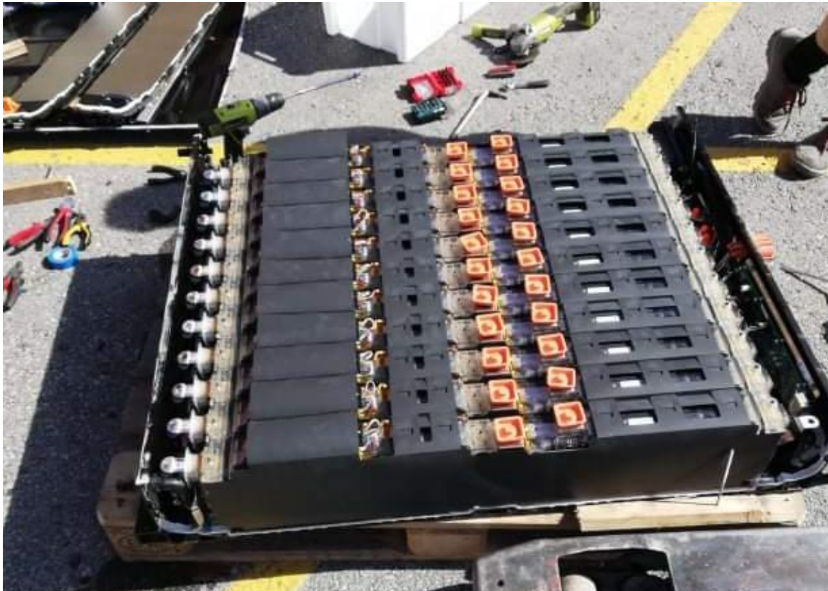
Joonis 6.1 B250e akukast.
