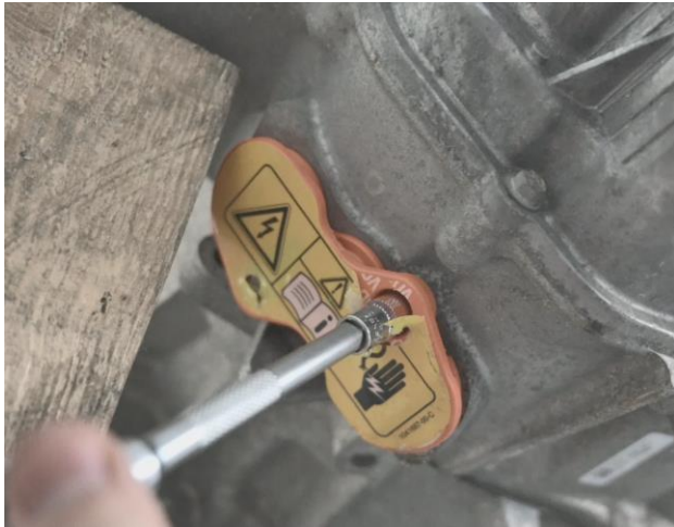
Joonis 3.1 Mootori inverteeri kaablite poldid.
