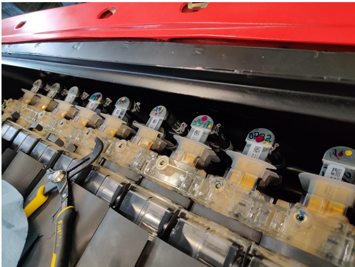
Joonis 6.12 B250e akumoodulite jahutus.
