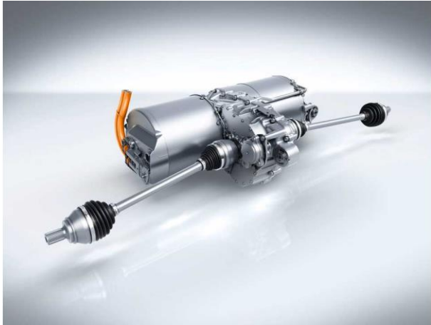
Joonis 4.1 B250e elektrimootor. [24]
