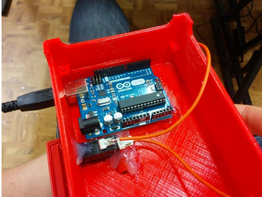
Sele 5.2.2. Mikrokontrolleri asetus juhtploki korpuses
