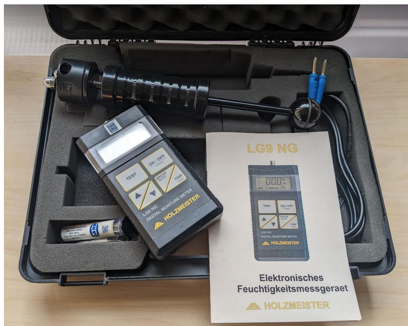
Joonis 3.1 Digitaalne niiskusmõõtja Holzmeister LG9 NG (autori foto)
