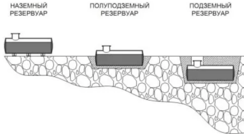
Joonis 2.1. Naftatoodete säilitamiseks mõeldud reservuaaride tüübid [4]
