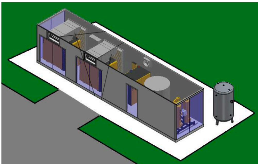
Joonis 3.2 Seadmetega gaasilise lämmastiku jaama konteineri üldvaade [11]
