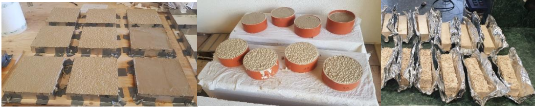
Joonis 2.2 Vasakult: plaadikujulised katsekehad kuivamas Moostes, silindrikujulised katsekehad kuivamas Moostes, prismakujulised kangid Tartu kolledžis (autori fotod)
