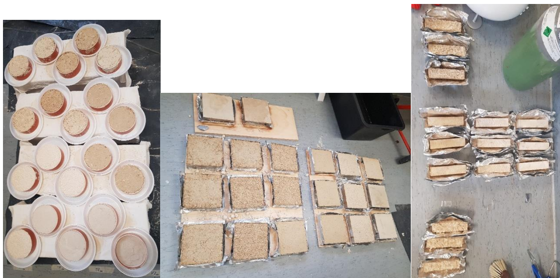
Joonis 3.3 Katsekehad Tartu kolledži katsemajas nr. 1. Vasakult: silindrikujulised katsekehad, plaadikujulised katsekehad ja prismakujulised kangid (autori fotod)
