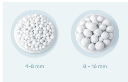
Joonis 1.3 Paisutatud klaasgraanulid erinevates fraktsioonides [39]
