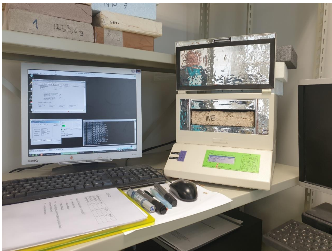
Joonis 3.11 Paremal mõõteseadme Fox 200 koos katsekeha IIIE-ga, vasakul mõõteseadme parameetrite määramiseks ja tulemuste saamiseks arvuti (autori foto)
