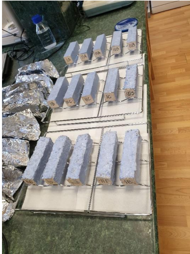
Joonis 3.7 Hüdroisolatsioonimastiksiga kaetud katsekehad (autori foto)
